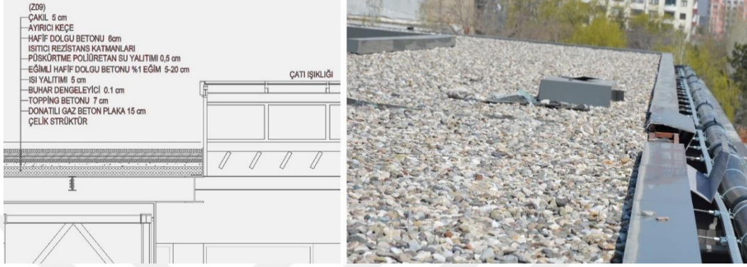
Görsel 4.20. Çatı Sistem Detayı (YİDB Arşivi)
