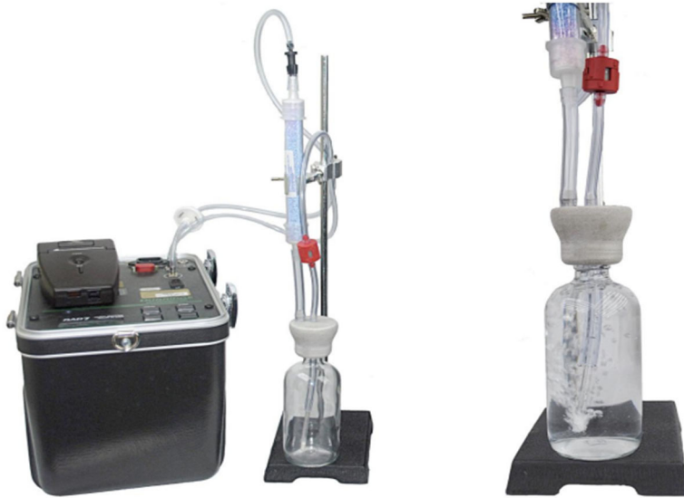
Şekil 3.7. Su örneğinin RAD7 ye bağlanması ve köpürtülmesi
