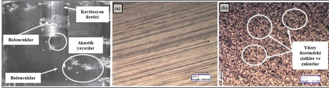
Şekil 3.4. (a) Testlerden önce paslanmaz çelik, (b) 80 dakika sonra titreşimli test cihazı ile aşınma görseli (Laguna-Camacho ve diğ., 2013)
