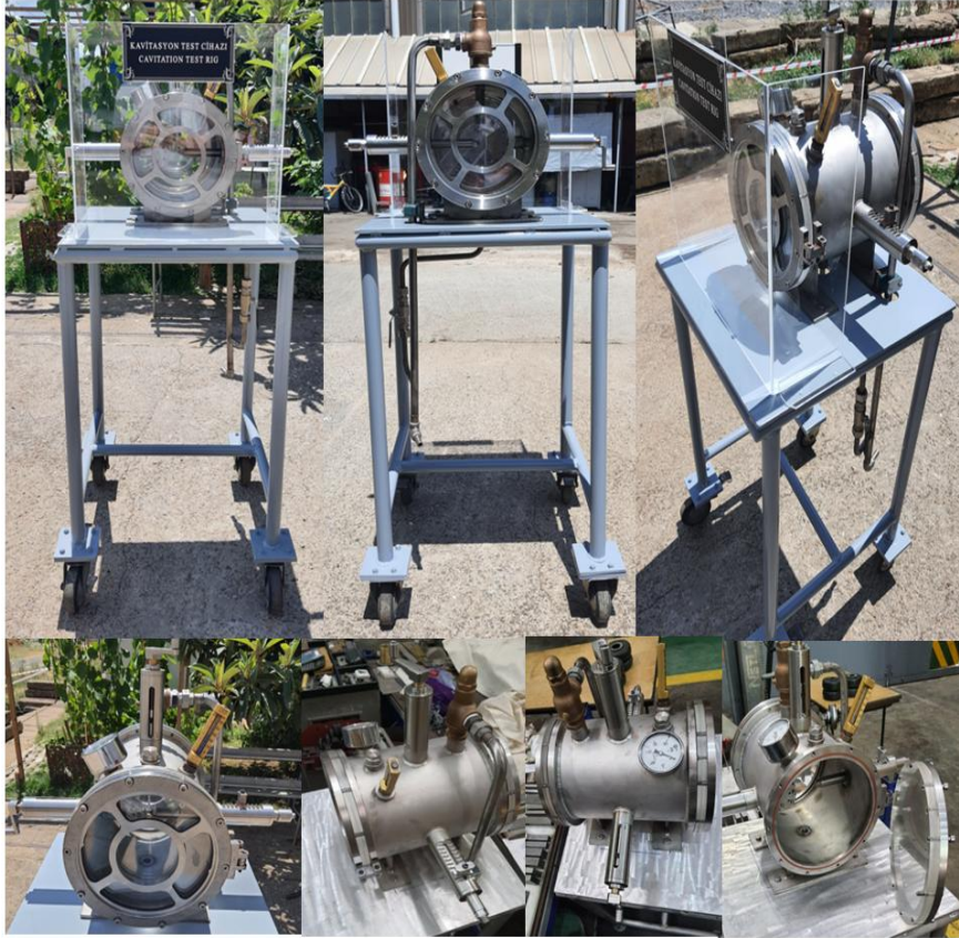
Şekil 4.6. Kavitasyon su jeti erozyonu test düzeneği imalat ve montaj aşaması sonrası görselleri
