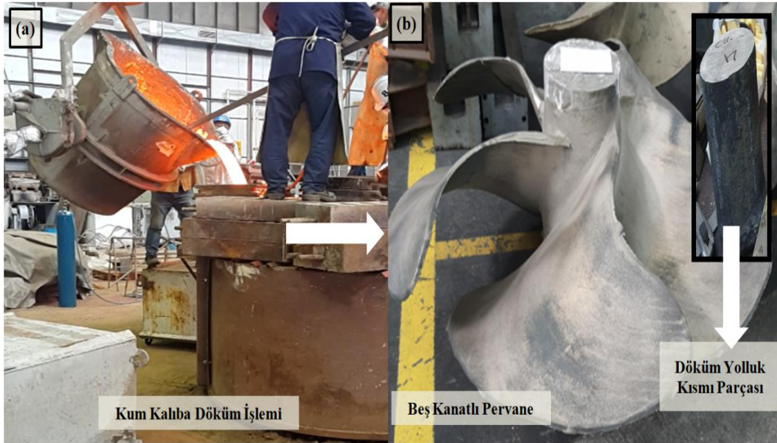
Şekil 4.1. MAB-CU4 alaşımı döküm aşaması basamakları (a) döküm aşaması (b) beş kanatlı gemi pervanesi
