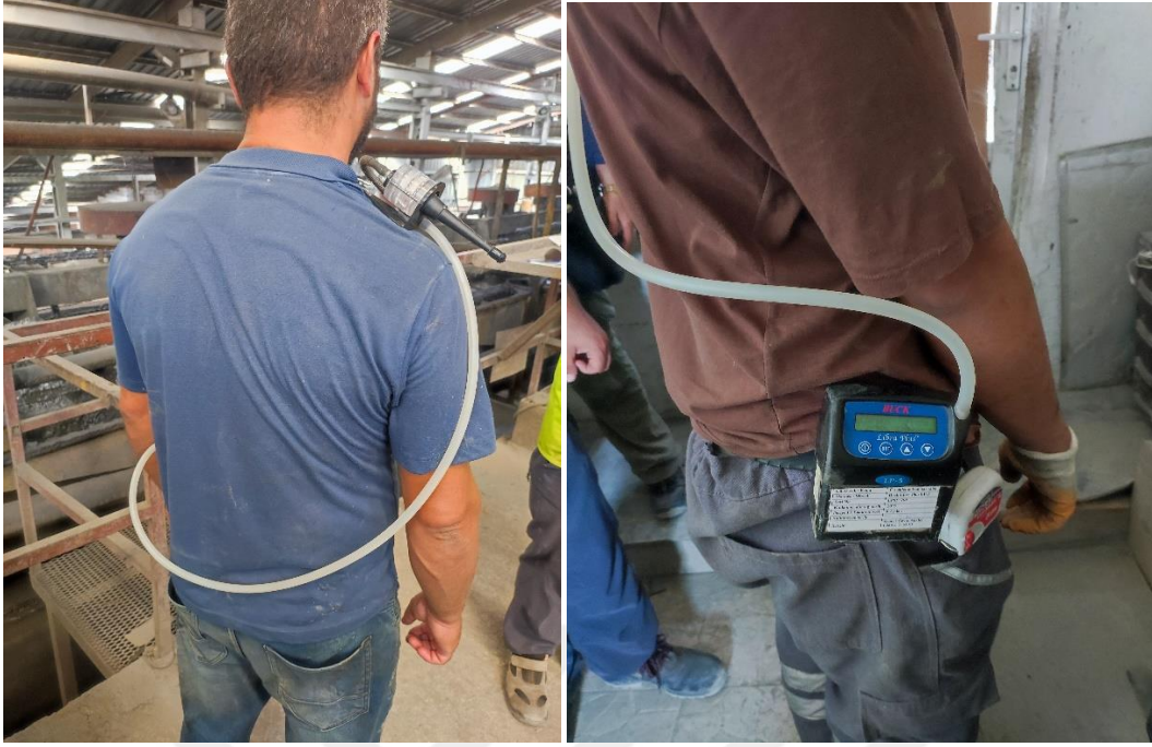
Şekil 6. MDHS 14/3 Standardına Göre Kişisel Solunabilir Toz Maruziyeti Ölçümleri ve ölçümlerde kullanılan Buck Libra Plus LP-5 cihazı
