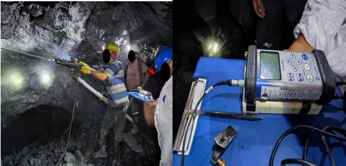
Şekil 4. Tüm vucüt ortam ölçümlerinde kullanılan Svan 958 gürültü ve üç eksenli titreşim ölçüm cihazı
