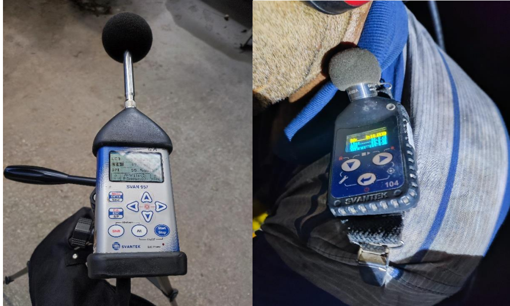
Şekil 1. İç ortam gürültü ölçümlerinde kullanılan Svantek-957 marka (solda) ve kişisel gürültü ölçümü için kullanılan Svantek-Sv104 marka dozimetre cihazları (sağda)
