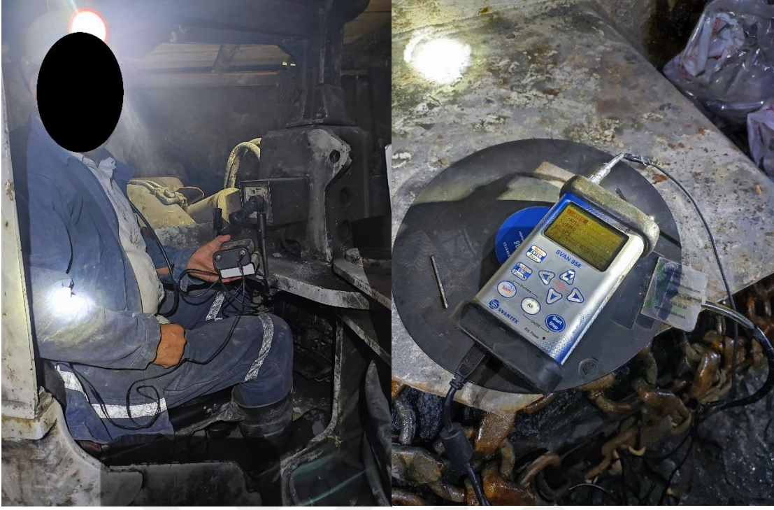
Şekil 4. Tüm vucüt ortam ölçümlerinde kullanılan Svan 958 gürültü ve üç eksenli titreşim ölçüm cihazı
