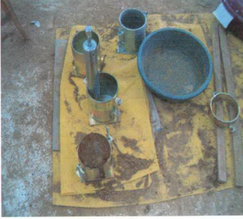
a. 15.24 cm (6") lik kalıp ve 2.49 kg lık tokmak.
