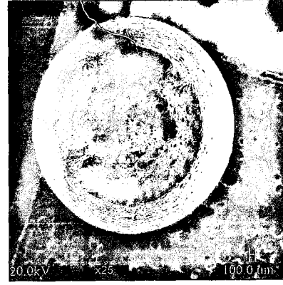
Şekil 5.9 Çelik-1 numunelerinin farklı sıcaklıklarda elde edilen kırık yüzey resimleri.
