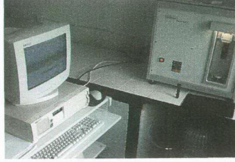
Şekil 2. 11 Tiftik Örneklerinde Elyaf Mukavemeti ve Elastikiyetinin Analiz Edildiği Cihaz Seti (FAFEGRAPH HR + ME).
