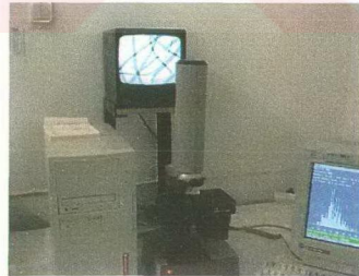
Şekil 2.9. (solda) ve 2.10 (sağda). Tiftik örneklerinden elyaf inceliği, kempli ve medullalı elyaf oranlarının analiz edildiği cihaz seti (USTER OFDA 100). Tiftik örneği, önce cihazın özel blenderinde homojen parçalara ayrılır ve özel cam aparata yerleştirilir (Şekil 2.9, sağ tarafındaki siyah aygıt ve üzerindeki cam aparatı). Sonra da cam aparat optik okuyucuya (Şekil 2.10) yerleştirilerek cihazın ekranından ve bilgisayar çıktısından analiz sonuçları alınır.
