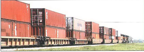
Şekil 26: Çift kat konteynerlerin platform vagon ve cepli vagonlarda taşındığı katar
