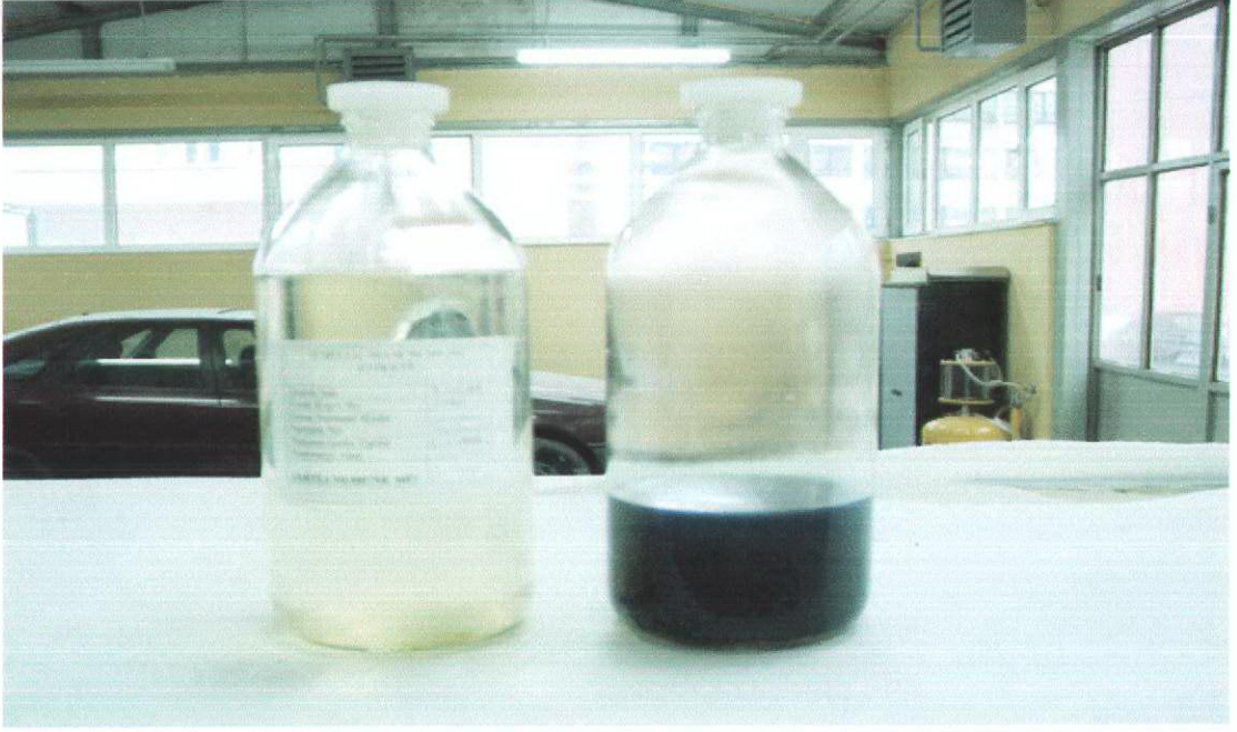
Şekil 5.3. Damıtılmış yakıt ve kalan tortu.
