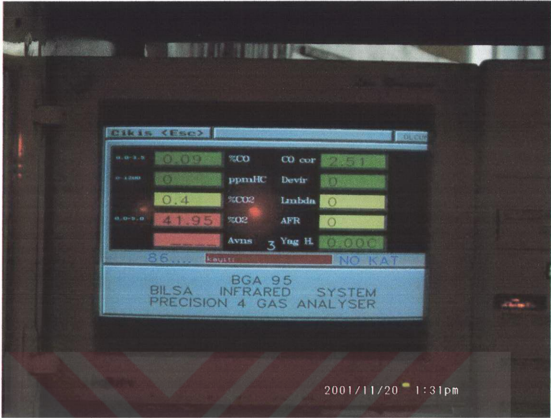
Şekil 4.6. Motor test cihazıyla ölçülen niteliklerin detaylı gösterimi.
