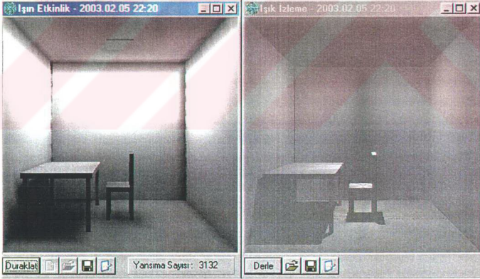
Şekil 6.17. Işın izleme ve ışın etkinlik metodlarının 3132 yansımadan sonra oluşan ışık dağılımı
