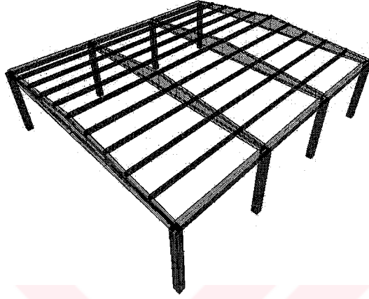
Şekil 3.1: Tipik tek katlı birleşimi mafsallı prefabrik sanayi yapısı modeli
