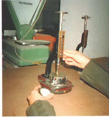
Şekil 3.5 Vicat Sondası ve Vicat Aleti
