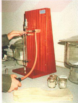
Şekil 3.2 Çimentonun Özgül Yüzey Değerinin Ölçümü
