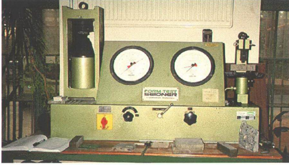
Şekil 3.16 Eğilme ve Basınç Mukavemetini Ölçen Hidrolik Pres
