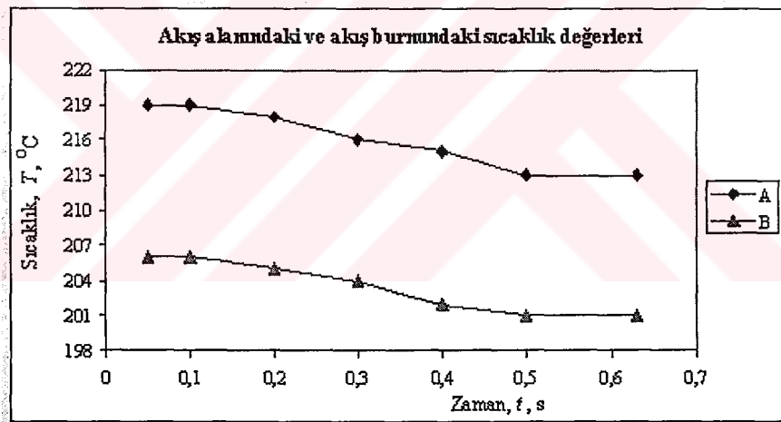
Şekil 6.15. II. grup enjeksiyon parametreleri ile yapılan analizde, akış alanındaki ve akış burnunda zamana göre sıcaklık dağılımı (A: Akış alanının sıcaklığı, B: akış burnuna yakın bölgenin sıcaklığı)
