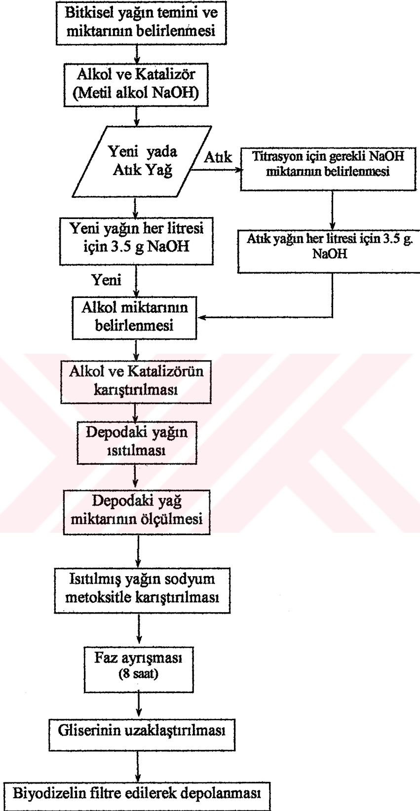
Şekil 3.3, Biyodizelin üretim akış şeması (Öğüt 2003, Tickell 2000, http://www.woodfellas.org 2003)
