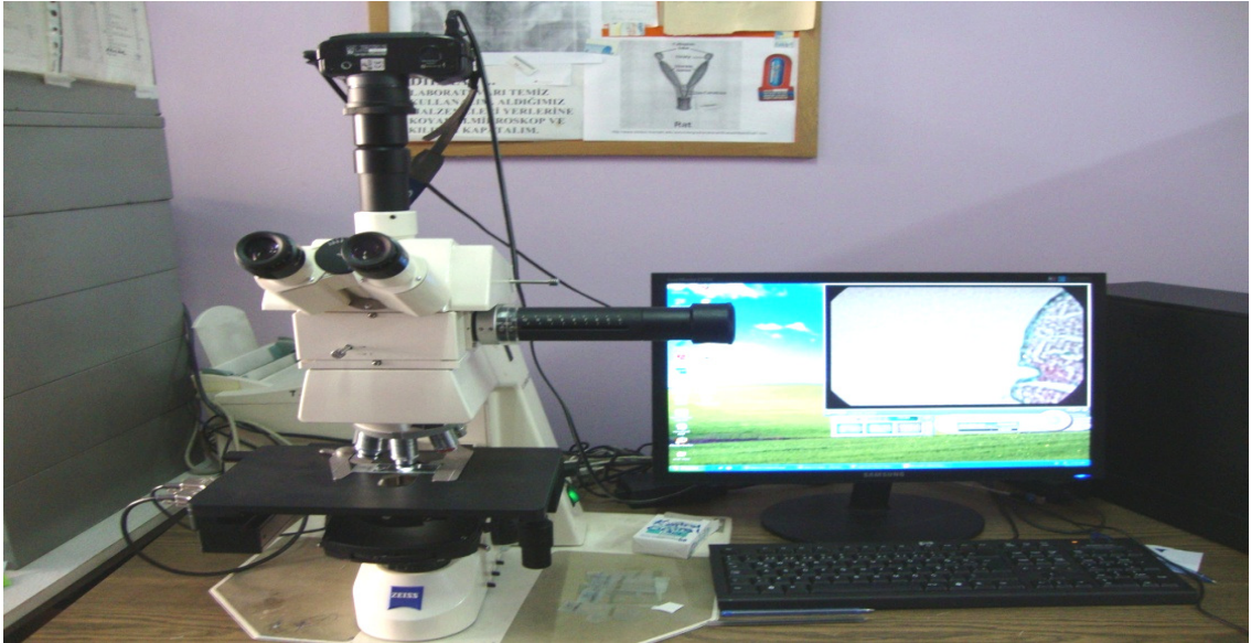
řekil 13. Sayımda kullanılan fotoęraf atařmanı ilave edilmiř mikroskop ( Zeiss Axioskop 4 Carl Zeiss Göttingen Germany).
