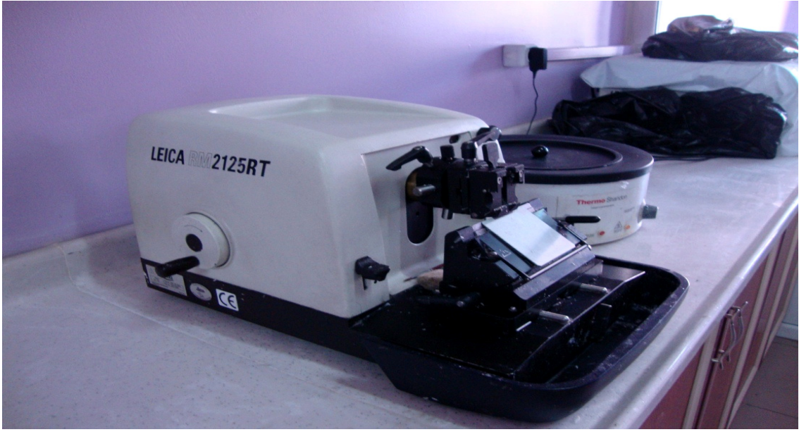
řekil 12. Kesit alınan mikrotom (Leica Model 2125RT Çin malı (Nussloch).
