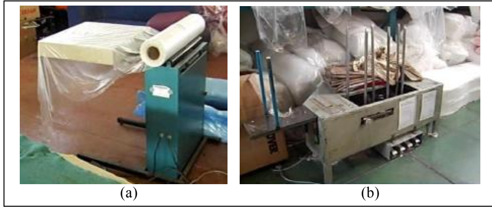
Resim 2.10. Sünger giydirme makineleri a) Sünger vakum, b) Sünger ezme makinesi
