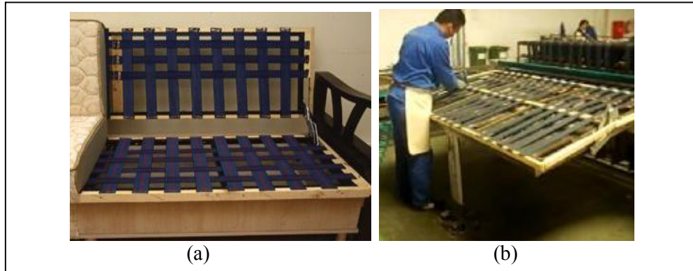
Resim 2.2. Kolan a) Koltuk kolanı, b) Kolan gerdirme makinesi
