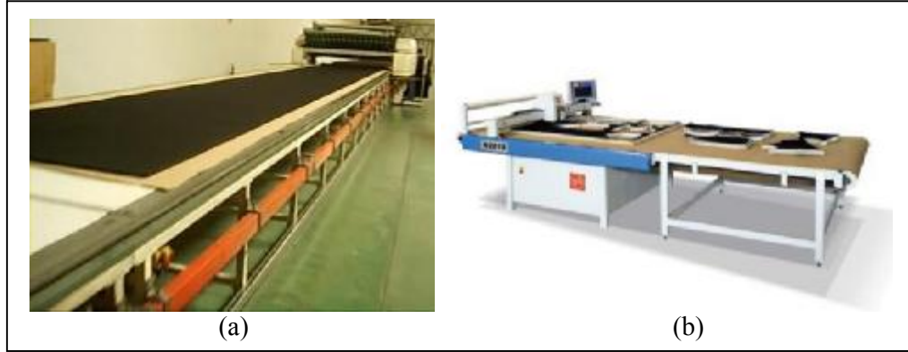
Resim 2.13. CNC kumaş makinesi a-Serme b-Kesim
