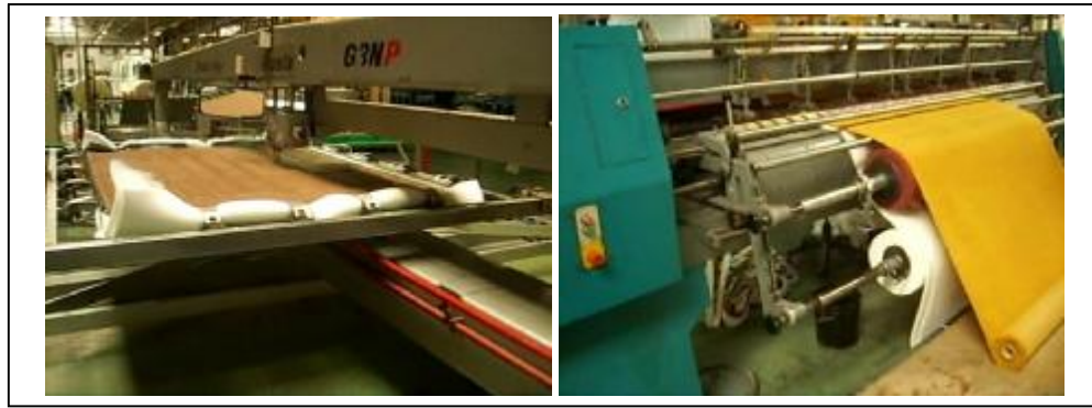
Resim 2.14. Kapitone makinesi a) Tek çift kafa kapitone makinesi b) Çoklu iğneli kapitone makinesi
