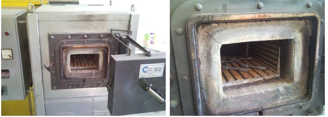
Şekil 3.1. Homojenizasyon işleminin yapıldığı ısıtıl işlem fırını
