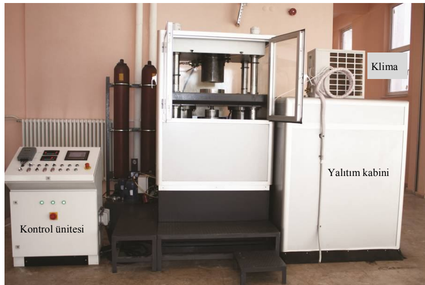
Şekil 3.12. Nakajima deneylerinin yapıldığı deney ünitesi
