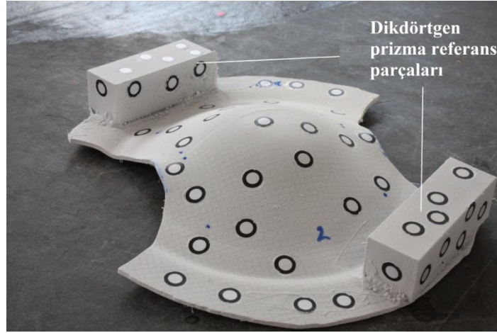
Şekil 3.32. Flanş bölgesine dikdörtgenler prizması şeklinde parçalar yapıştırılmış örnek bir numune
