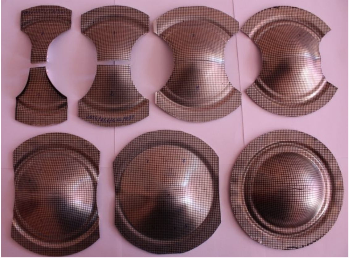
Şekil 4.15. Al 2024-T4 Nakajima numunelerinde yırtık kubbe tepe noktasına oldukça yakın oluşuyor
