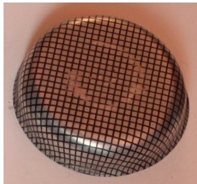
Şekil 4.44. Klasik derin çekmeyle şekillendirilen 60 mm çapında silindirik kap
