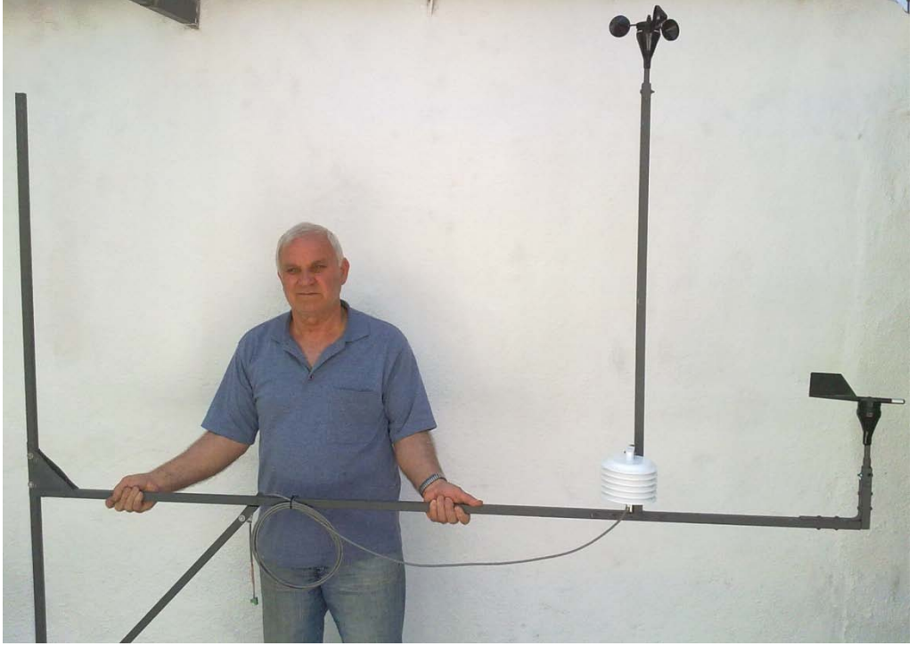
Şekil 3.5 Meteorolojik Sensörleri Bağlamak İçin Tasarlanan Platform
