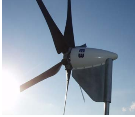
Şekil 1.6Rüzgârı Arkadan Alan (Down-Wind) Rüzgâr Türbini
