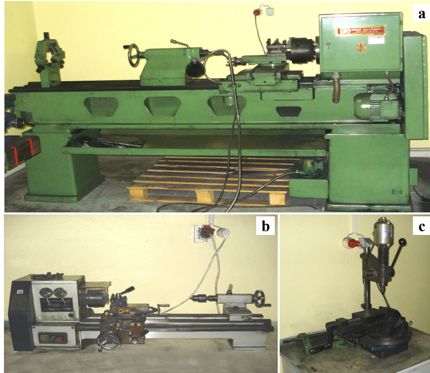
Şekil 3.5. Grafitlerin işlenmesinde kullanılan (a) Büyük torna, (b) Küçük torna ve (c) Yönlü matkap.
