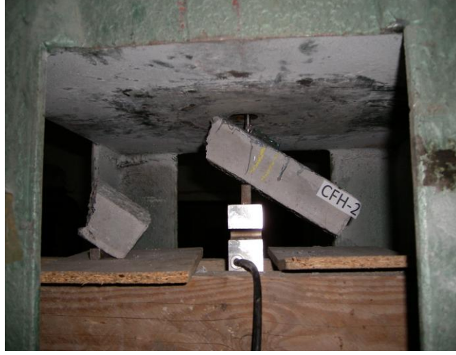
Ek-6. CFH2-5 Kirişlerin Deney Sonrası Durumu
