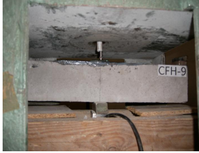
Ek-8. CFH9-12 Kirişlerin Deney Sonrası Durumu
