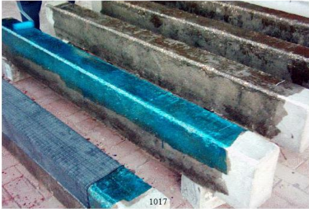
Resim 3.1. CFRP ile güçlendirilmiş kirişler
