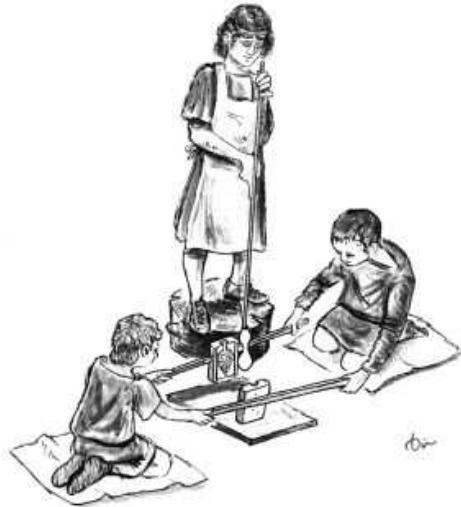
Çizim 10: Kalıba Üfleme Tekniği
