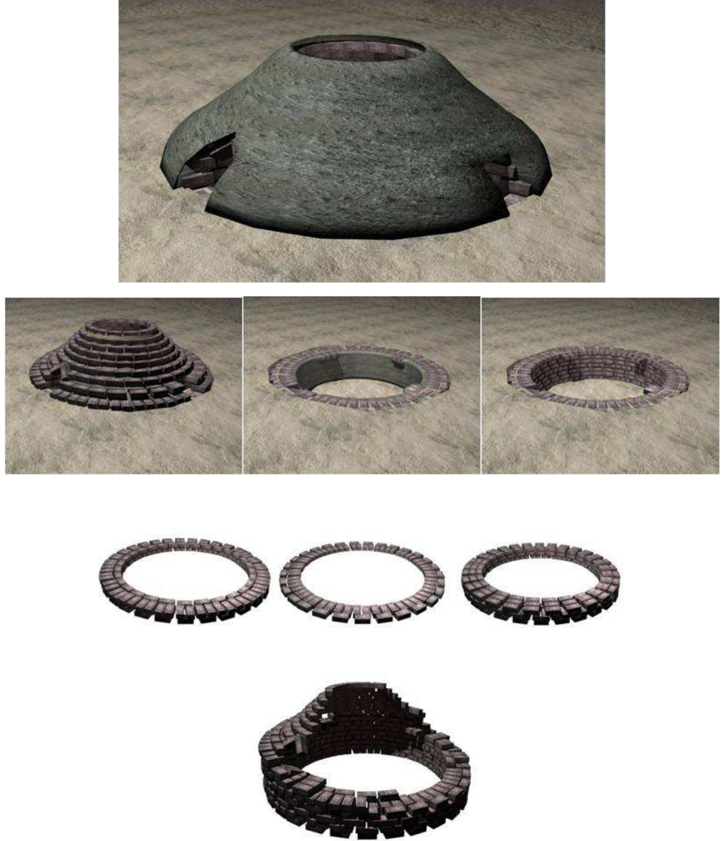
Resim 11: Tell-el Amarna'daki Kazılarda Bulunan Cam Fırını Kalıntılarından Yola Çıkararak Dr. Paul T. Nicoholson Tarafından Hazırlanmış Mısır Cam Fırınları Rekonstrüksiyon ve Kesitleri
