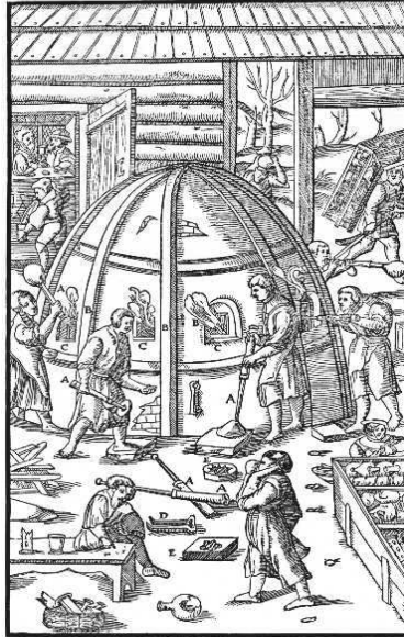
Çizim 20: Geogius Agricola'nın 1556 Tarihli "De re Metalica" İsimli Kitabından Venedik Üç Bölümlü, Tek Başına Kullanılan Cam Fırını (Küçükerman'dan)
