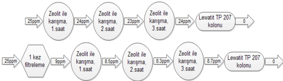
Şekil 5.9. Şekil 5.8’deki grafiklerin elde edilmesinde kullanılan yöntemlerin şematik gösterimi
