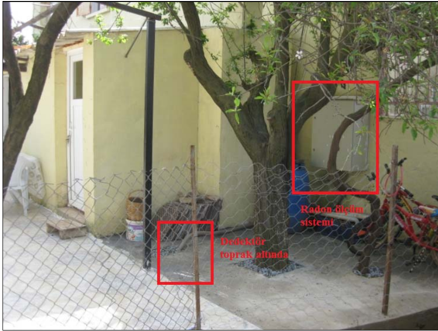
Şekil 3.12 Seferihisar Cumalı’ da kurulu olan sürekli radon ölçüm sisteminin dışarıdan görünümü (Toprağın altına yerleştirilen Alphameter radon ölçüm sistem bağlantı kablosu ile elde ettiği verileri duvarda yer alan panodaki veri depolayıcıya aktarmaktadır).
