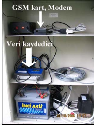
Şekil 3.13 Sürekli Radon ölçüm sisteminin bağlı olduğu pano ve içindeki donanımın görüntüsü.
