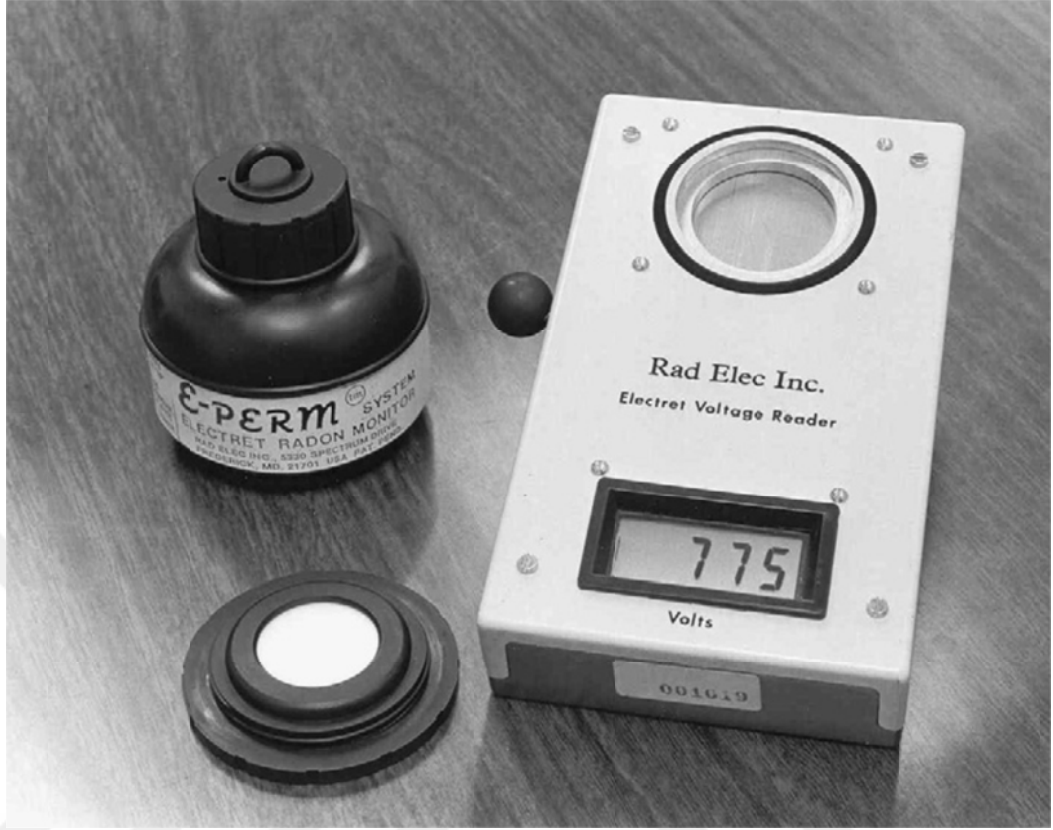
Şekil 2.11 Elektretli iyonizasyon odası, elektret ve elektret okuyucu.
