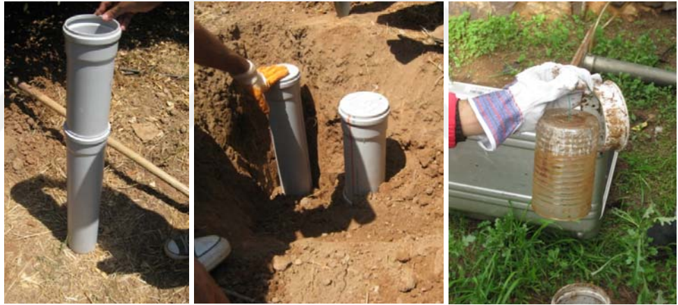
Şekil 3.5 Nükleer İz kazıma dedektörleriyle toprak gazı radon ölçümlerinde ölçüm düzeneklerinin oluşturulması.
