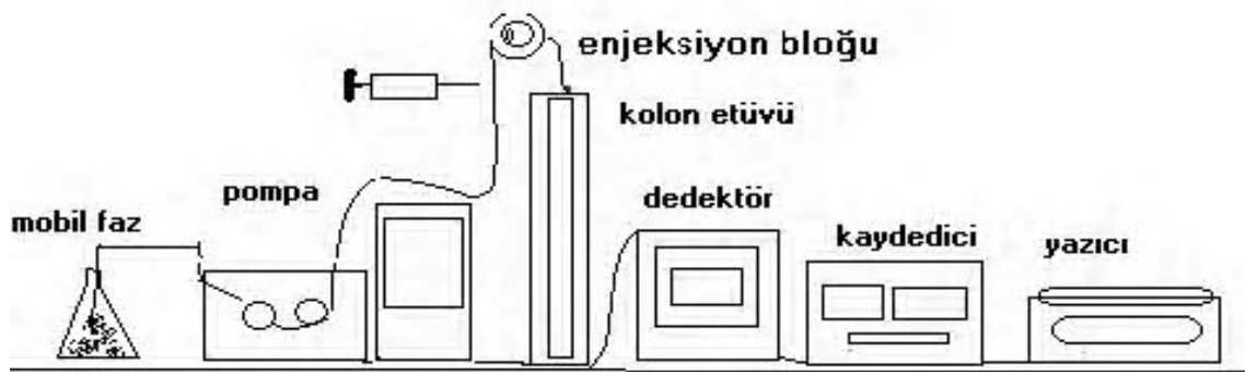
Şekil 2.9. HPLC cihazının şematik gösterimi
