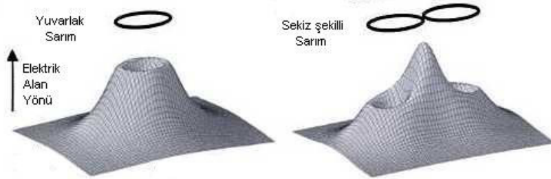
Şekil 2-4: Yuvarlak ve sekiz şekilli sarmallar ile oluşturulan elektrik alanlar
