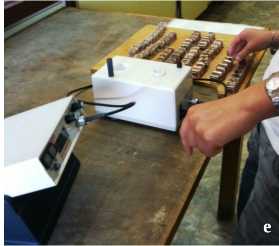
Şekil 4.59 Manyetik süseptibilite aleti ve ölçüm sistemi
