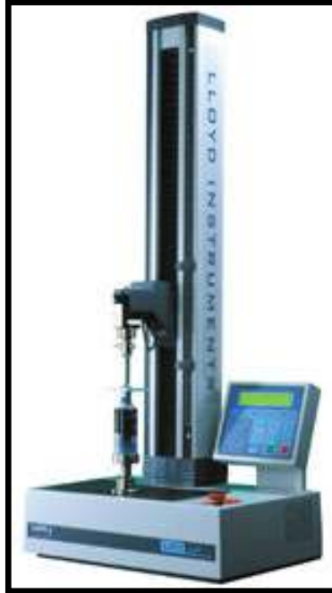
Şekil 5.21. Lloyd LRX Plus çekme cihazı (Lloyd instruments, 2011).
