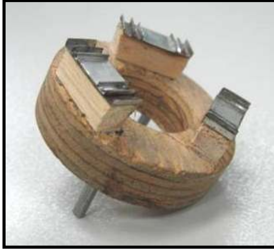
Şekil 5.35. Dalama ölçüm başlığı üzerindeki tınakların görünümü.
