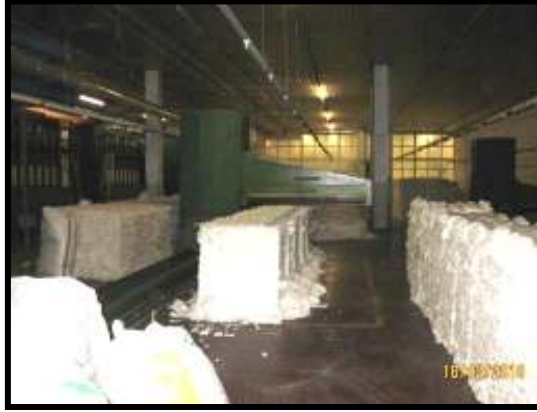
Şekil 5.3. Trützschler BDT 019 / 2300 Blendomat (Otomatik Balya Açıcı).
