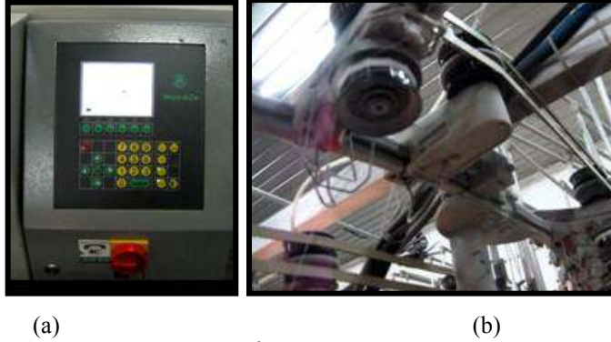
Şekil 5.13. (a) Kumanda paneli, (b) İplik uzunluk ölçüm aparatı.
