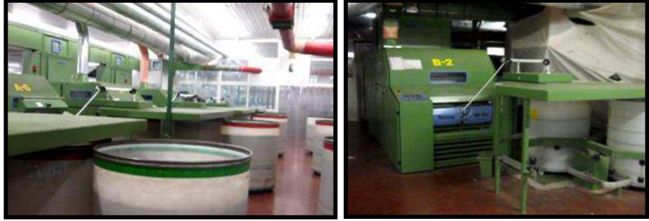
Şekil 5.8. Trützschler DK 903 Tarak Makinesi.
