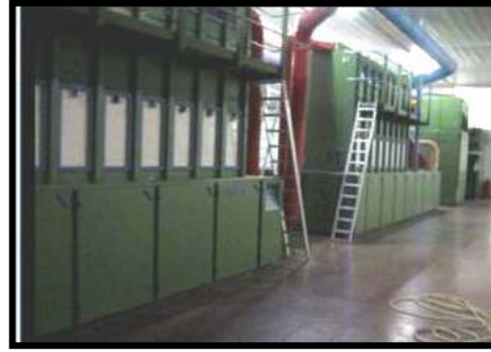
Şekil 5.6. Trützschler MCM 6/1600 Mikser.
