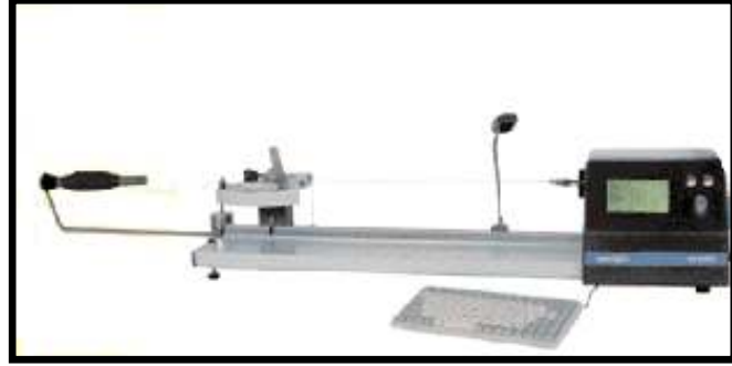
řekil 5.22. Zweigle D315 iplik bkm sayısı tespit cihazı.
