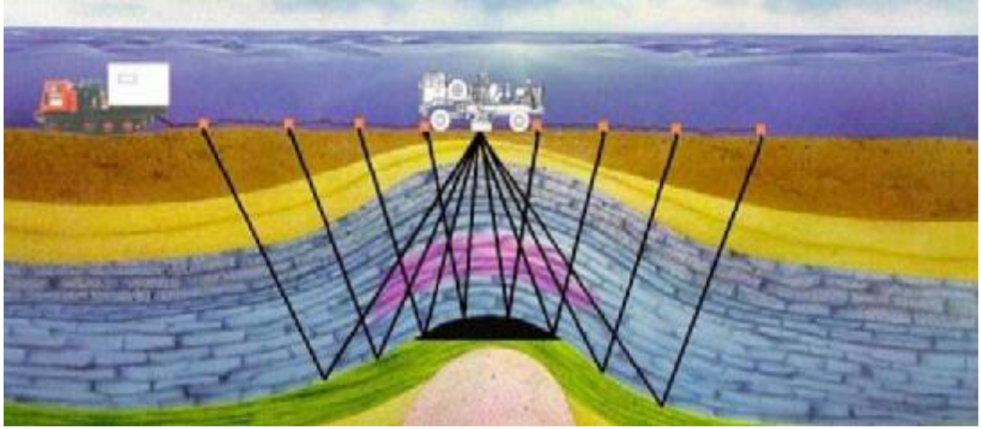
Şekil 3.4. Sismik yöntemin arazi uygulamasındaki şematik gösterimi.
