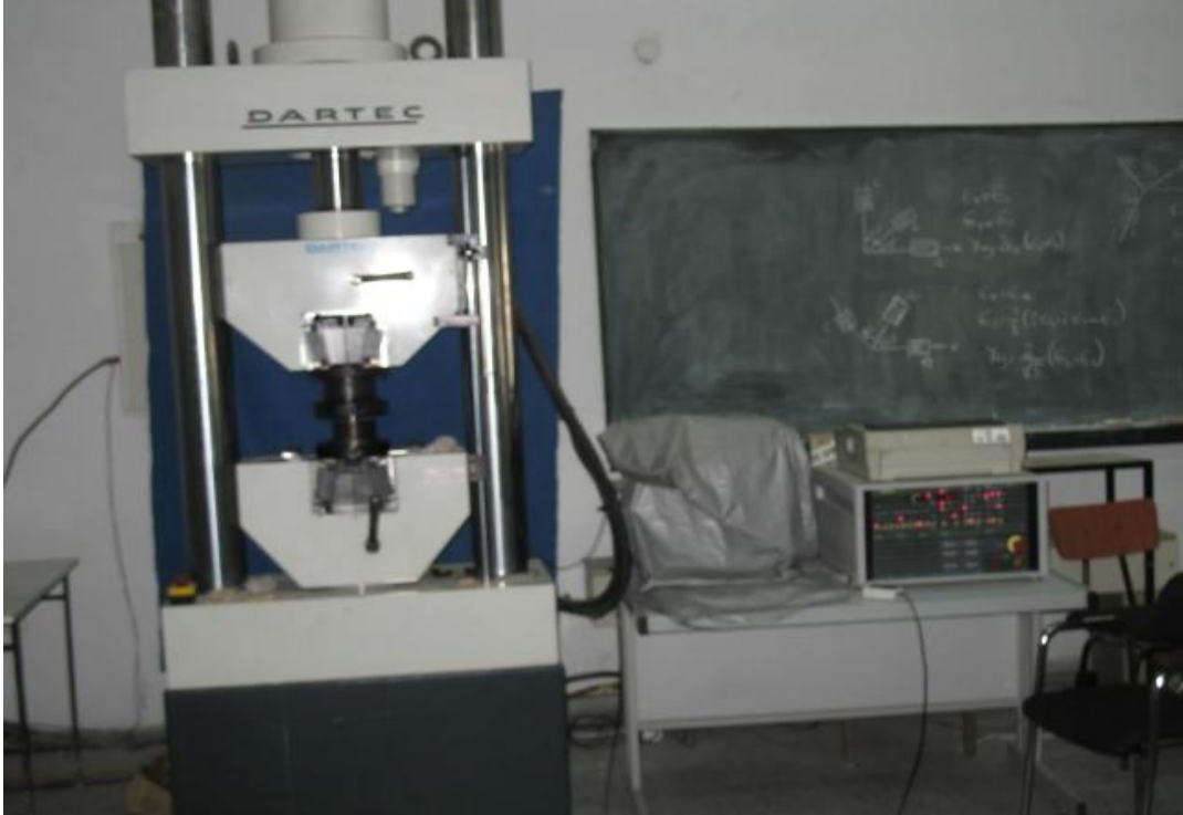
Şekil 6.7. Basma için kullanılan 60 tonluk Dartec RF çekme basma cihazı
