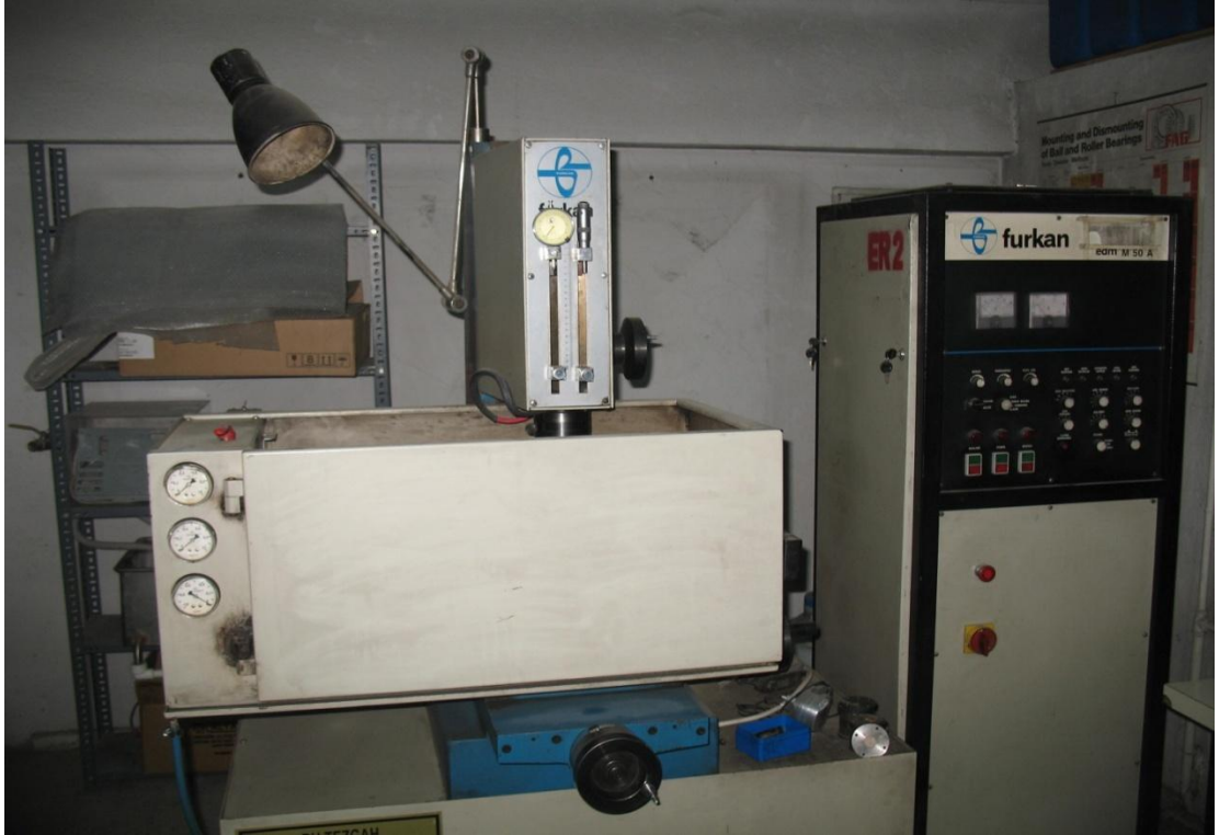
Şekil 6.18. Furkan EDM M50 A elektro erozyon tezgâhı
