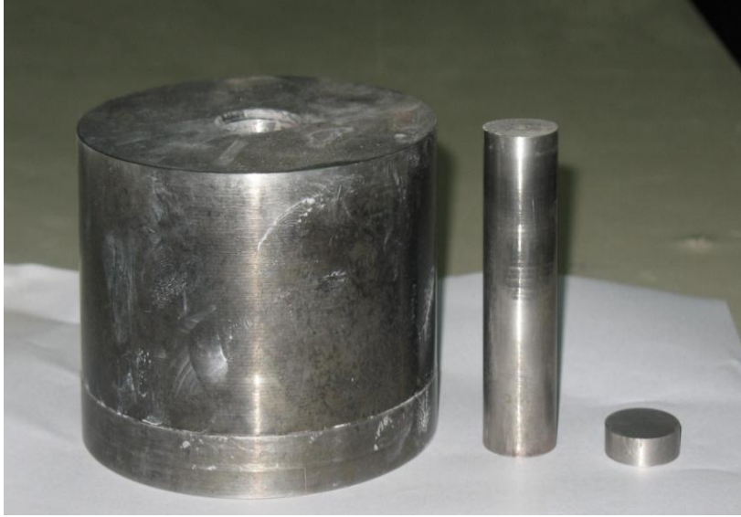
Şekil 6.2. 4340 ıslah çeliğinden yapılmış ve yeniden boyutlandırılmış kalıp
