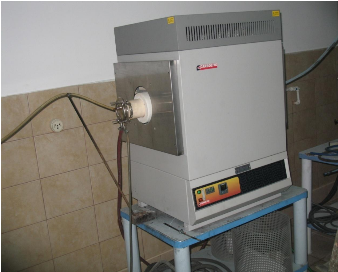
Şekil 6.16. Argon koruyucu atmosferli fırın GÜ, (Teknoloji Fakültesi)
