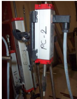
Şekil 4. 10. Yer değiştirmelerin ölçüldüğü Potansiyometrik pozisyon algılayıcı
