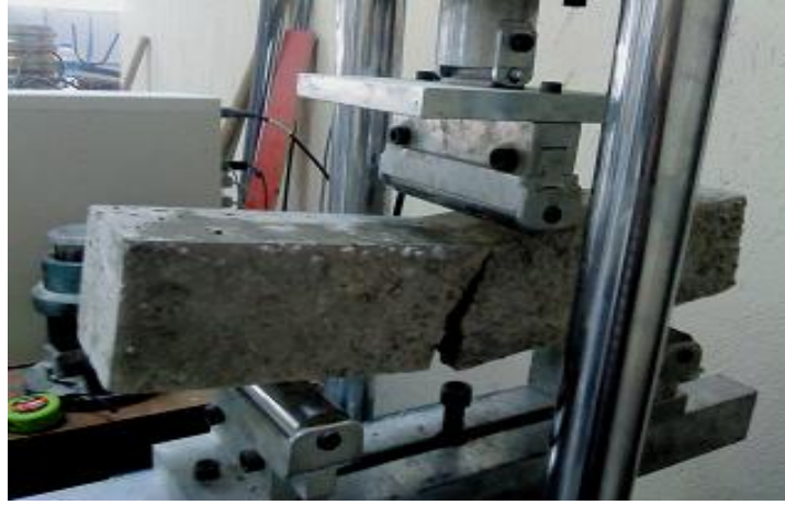
Şekil 5. 7. Beton eğilme dayanımı deneyi
