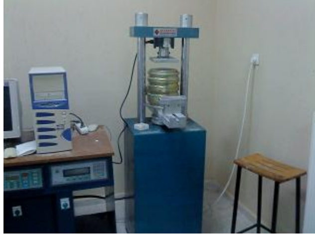
Şekil 3. 10. Eğilme deneyi test cihazı
