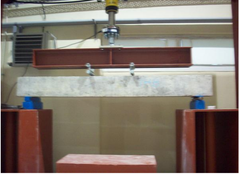
Şekil 4. 9. Basit mesnetli olarak yerleştirilen kiriş numunesi
