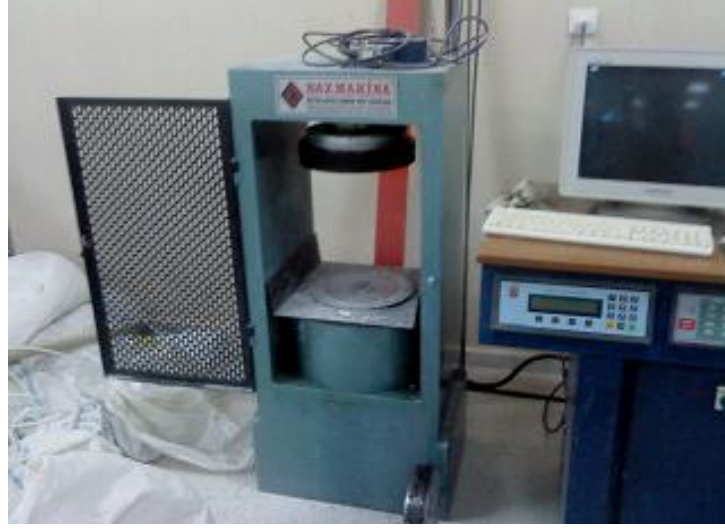
Şekil 3. 7. 300 ton kapasiteli tek eksenli basınç aleti
