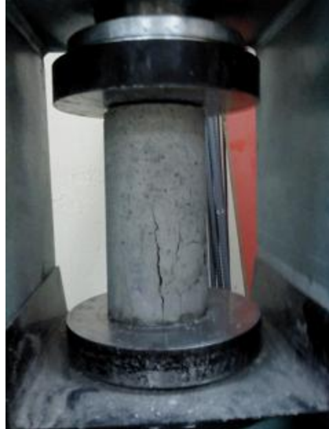
Şekil 5. 4. Beton basınç dayanımı deneyi
