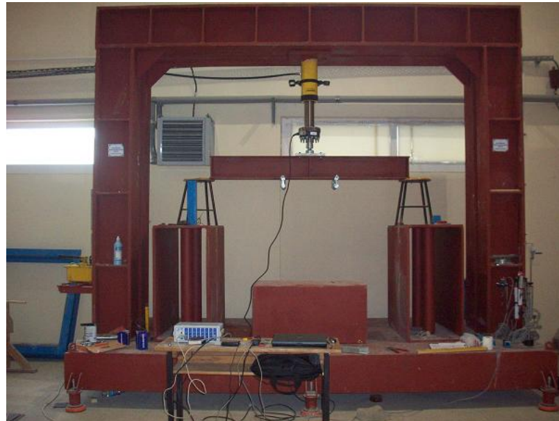
Şekil 4. 8. Betonarme kirişlerde uygulanan yükleme deneyi çerçevesi
