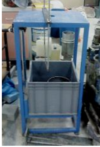
Şekil 3. 4. Özgöl ağırlık deneyinde kullanılan gereçler
