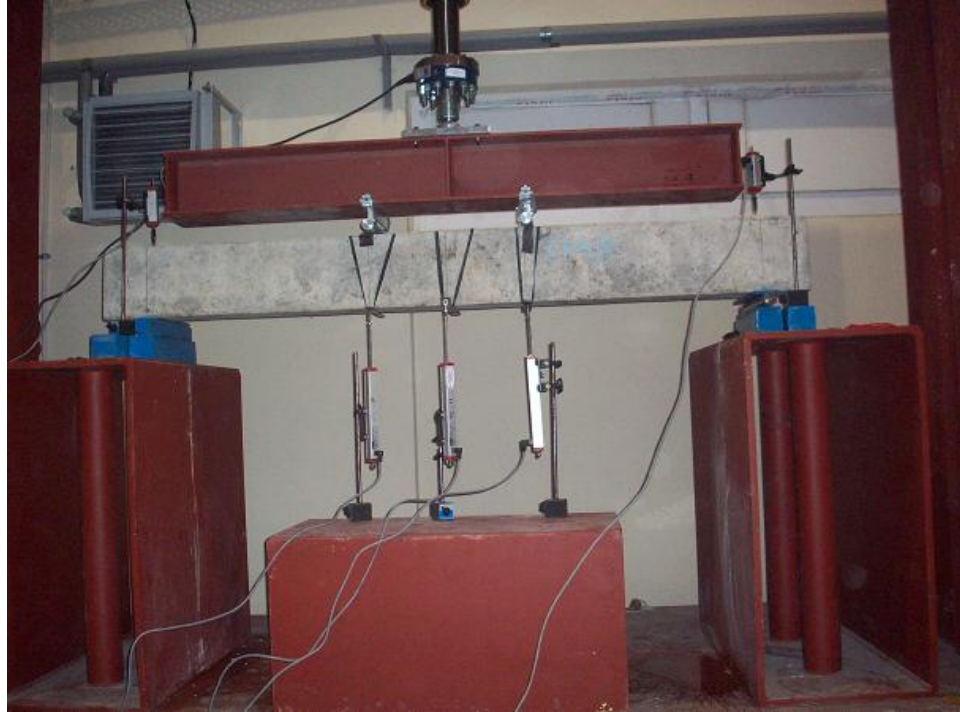
Şekil 4. 12. Potansiyometrik pozisyon algılayıcı yerleştirilen kiriş numunesi
