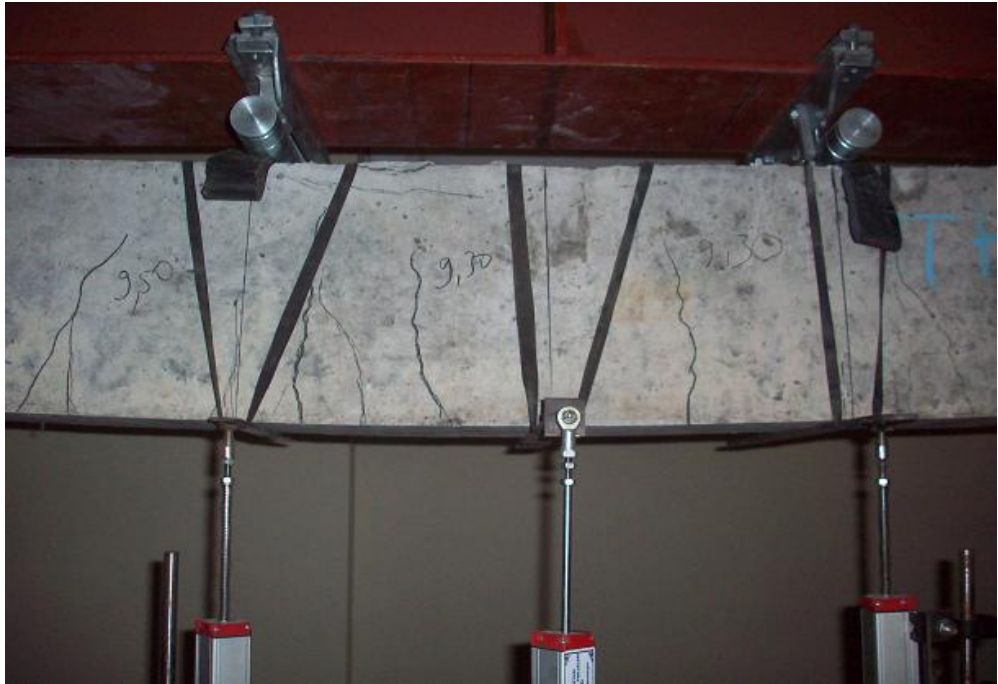
řekil 5. 16. THB serisi betonarme kiriřlerin ilk çatlak yükleri
