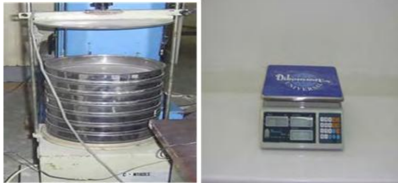
Şekil 3. 2. Elek analizinde kullanılan elek takımı, elek sarsma makinesi ve terazi
