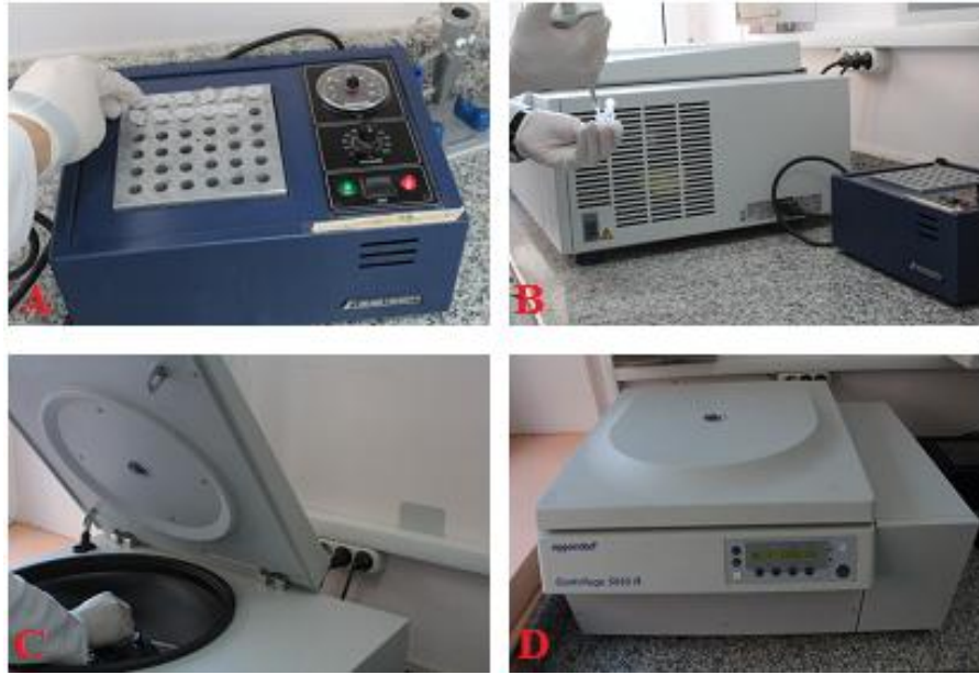
Şekil 3.7. A. Öğütülmüş Bitkisel Materyalin 65° C’de Bekletilmesi, B. Tüplerin Üzerine Solüsyonların Eklenmesi, C-D. Santrifüj İşlemi.
