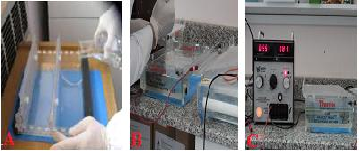
Şekil 3.9. A. Agaroz Jelin Dökülmesi, B. Agaroz Jelin Yüklenmesi, C. Agaroz Jelin Koşturulması
