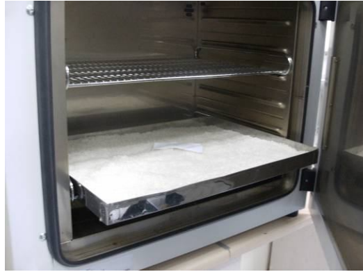
Şekil III.2.4 Etüvde Malzemenin Kurutulması
