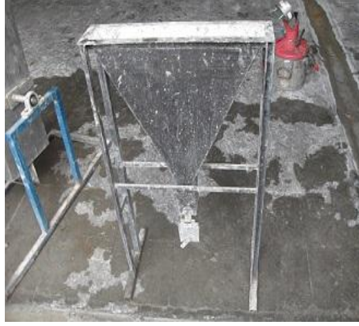
Şekil 2.4 : V-hunisi detaylı ölçüleri ve örnek resim.
