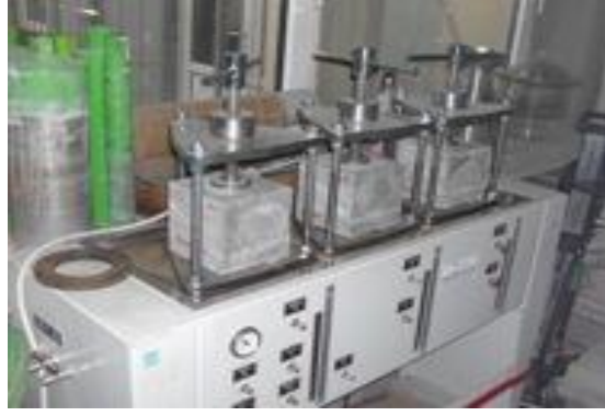
Şekil 3.19 : Basınçlı su emme test düzeneğine yerleştirilmiş numuneler.
