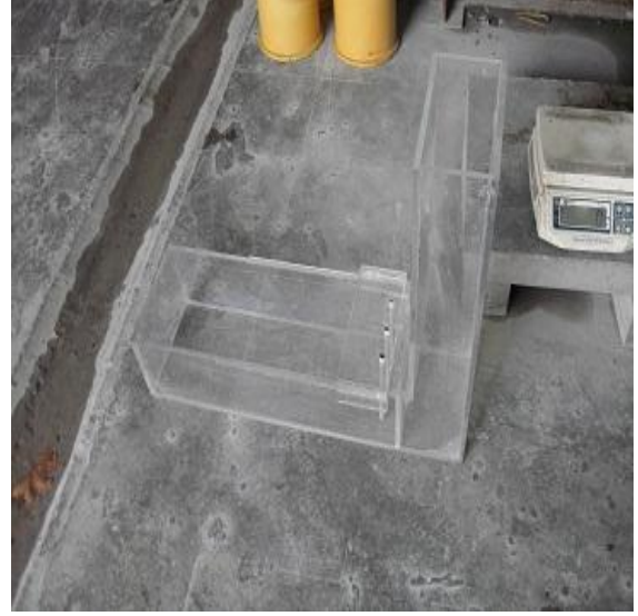
Şekil 2.5 : L-kutusu deney düzeneği ve örnek resim.
