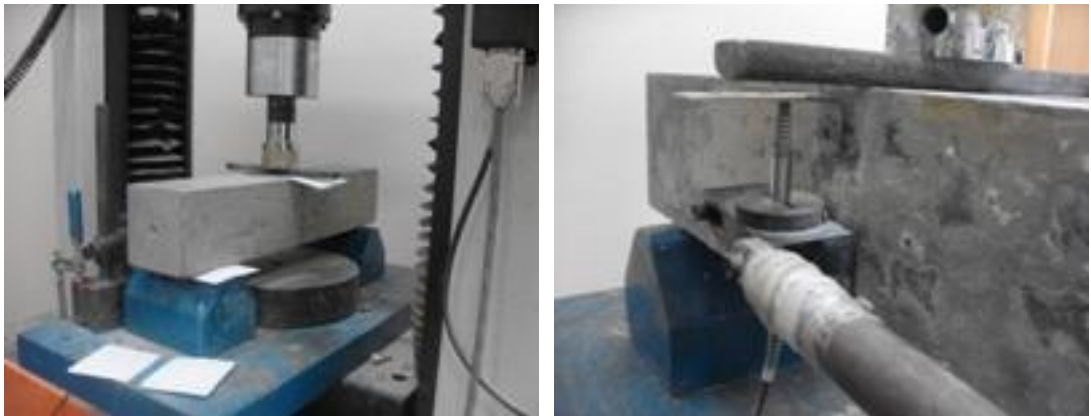
Şekil 3.13 : RILEM 3 noktalı eğilme deneyi düzeneği.
