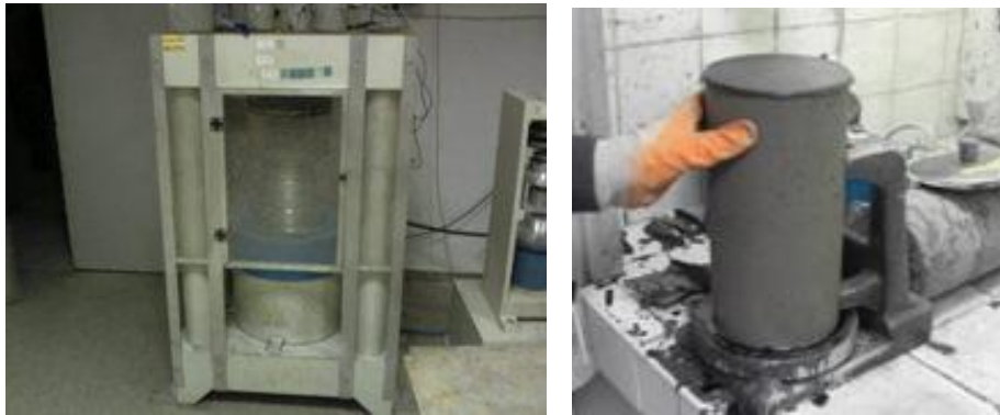
Şekil 3.10 : Dayanım gelişiminde kullanılan pres makinesi ve numune başlığı.
