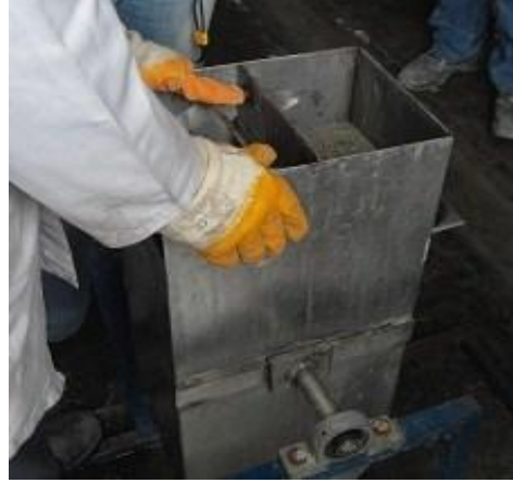
Şekil 2.6 : U-kutusu deney düzeneği ve örnek resim.
