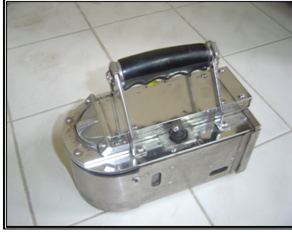
Şekil 4.1 MRE 113A Casella gravimetrik toz örnekleyicisi.
