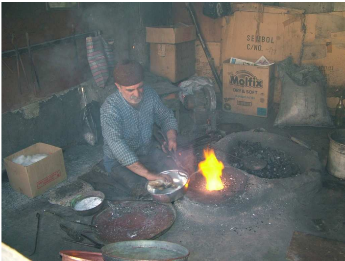
Resim 4.5 Kalay yapan bakırcı ustası ( Ali Kılıcı Arşivi)
