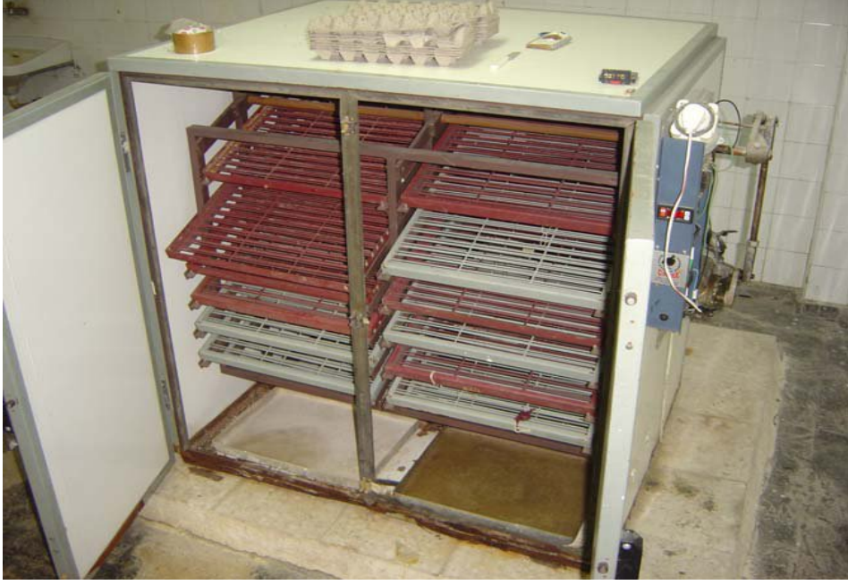
Şekil 3. 2. Kuluçka Makinesi Ön Gelişim Kısmı
