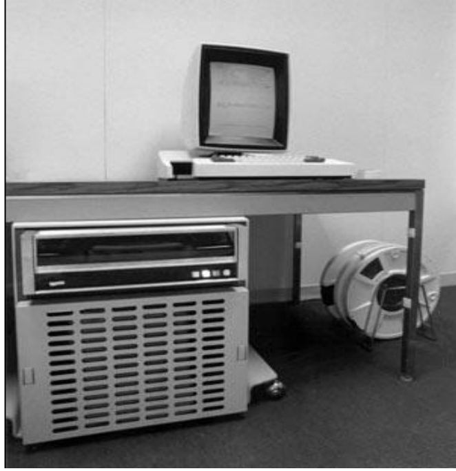
Resim 6: İşlemci, disk sürücü, ekran, klavye ve imleç cihazlarından oluşan ara versiyon Dynabook. 607
