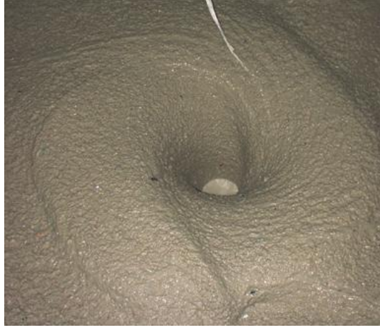
Şekil 2.10. Pulper cihazında karışım işlemi (Demircioğlu,1993).
