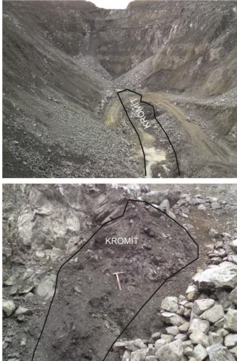
Şekil 4.24. Eđer Tepe Krom Ocađı Açık İřletme ve Krom Damarı
