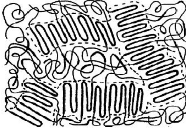
Şekil II. 5. Polyester-polieter blokopolimere ait mikroyapı modeli
