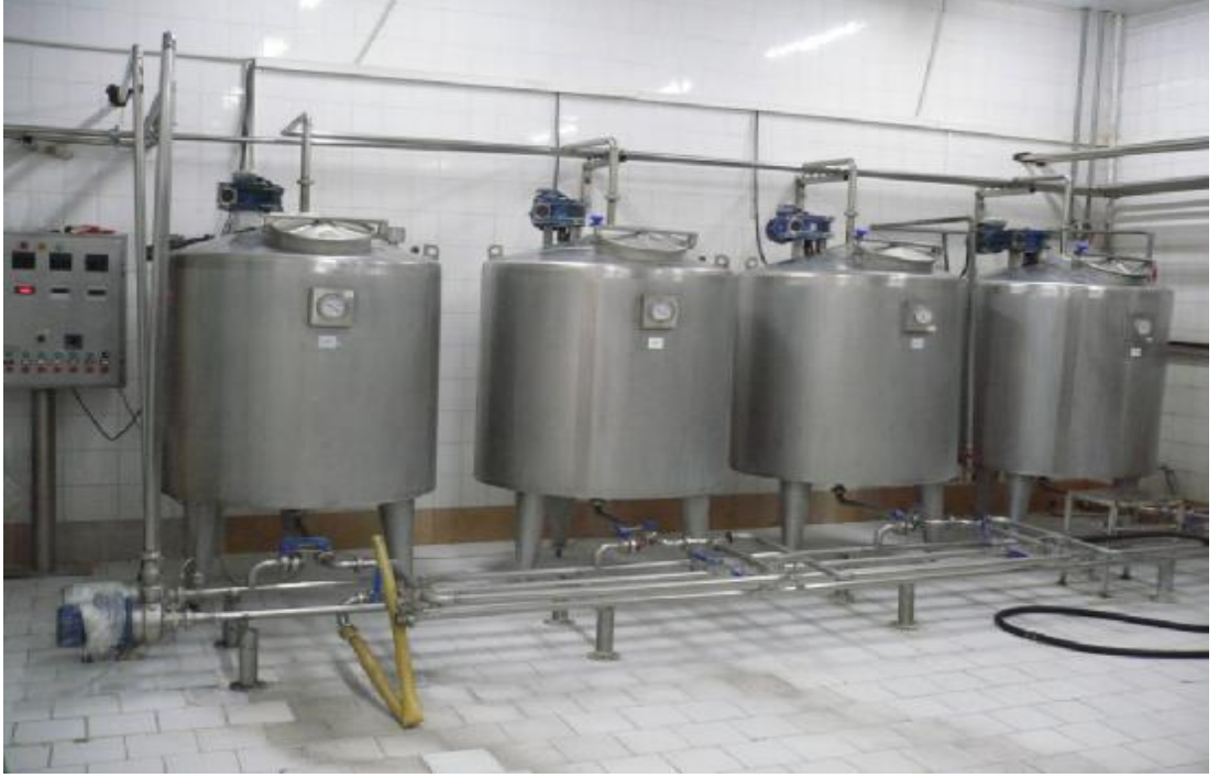
EK5. STARTER TANKLARINDA STARTER KÜLTÜRÜN İLAVE EDİLMESİ
