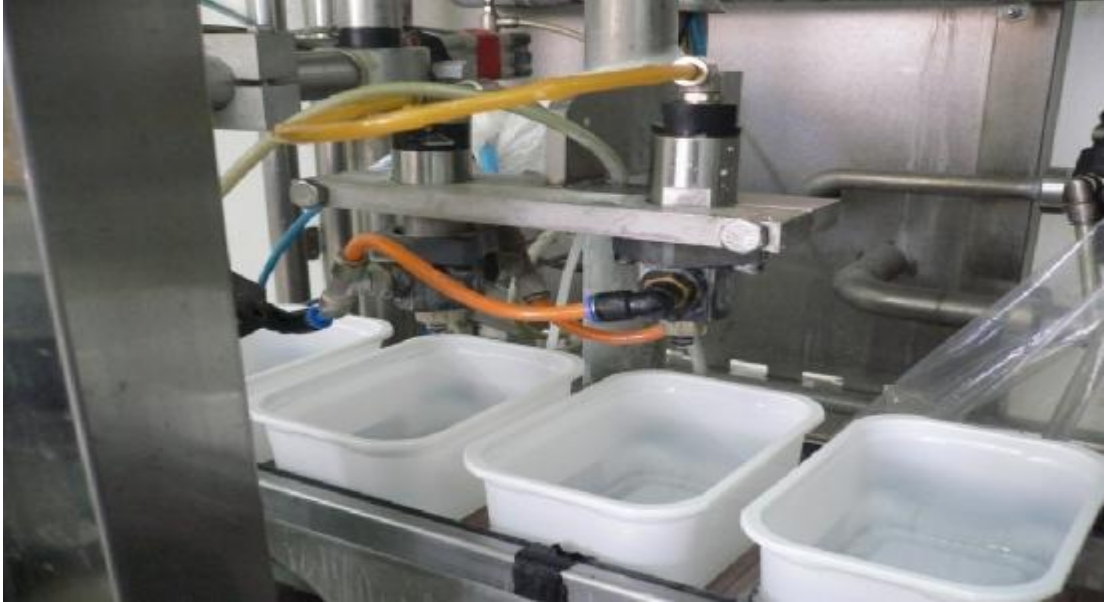
EK6. PEYNİR KAPLARINA YAPIŞKANLIĞI ENGELLEYİCİ MADDENİN PÜSKÜRTÜLMESİ
