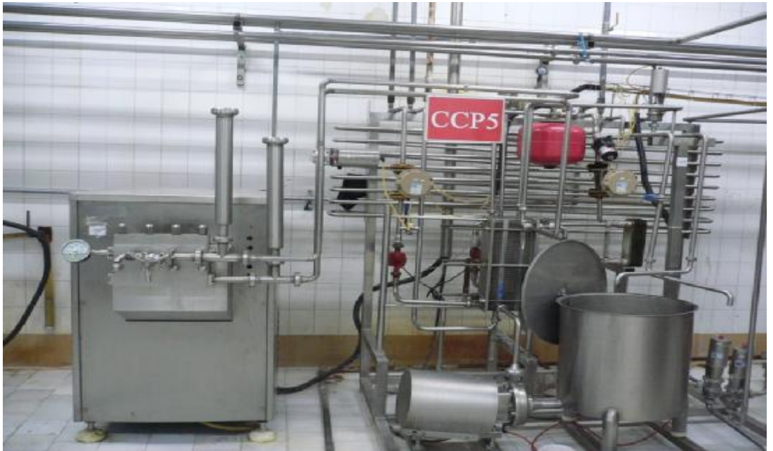
EY4. RETENTATIN HOMOJENİZASYON VE ISIL İŞLEME TABİ TUTULMASI
