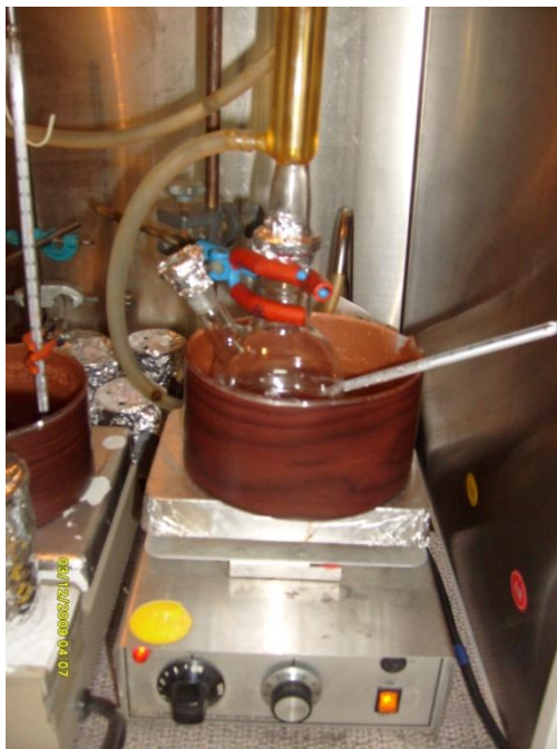
Resim 3.1. Polimerlerin hazırlandığı deney düzeneği
