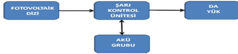
Şekil 2.3. Şarj kontrollü bataryalı sistemler
