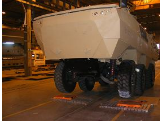
Şekil 2. 10 Yay sabiti ve lastik sönümü için ölçümlerden görüntü
