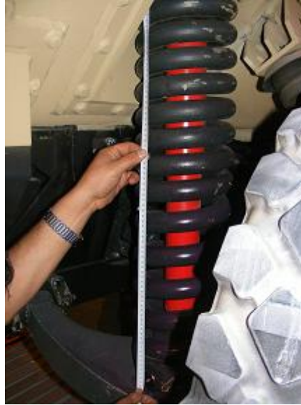
Şekil 2. 11 Yay katsayısı hesabı için alınan ölçümler
