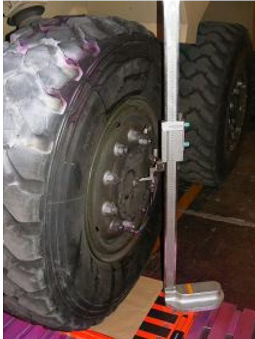
Şekil 2. 18 Lastik yay katsayısı için yapılan ölçümden görüntü
