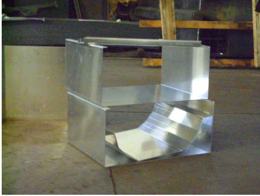
Şekil 28 Büküm işlemi tamamlandıktan sonraki görünüm
