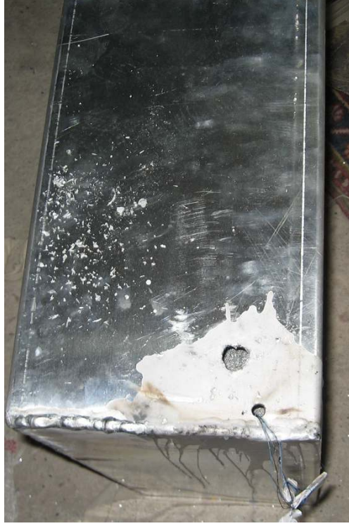
Şekil 32 Parafin ve talaş parçalarının doldurulması
