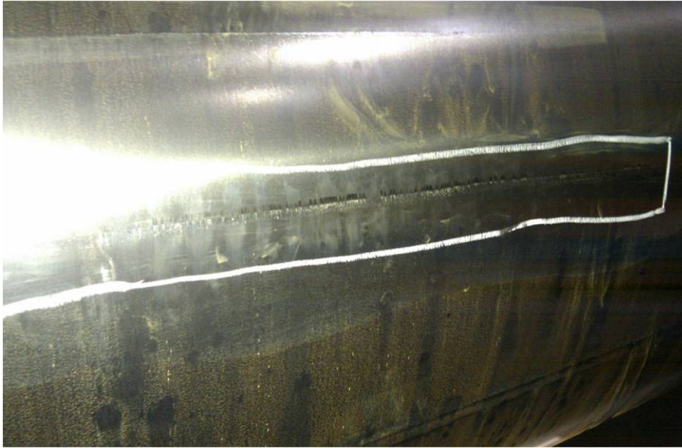
Şekil 9. 4: Sıcaklık farkından dolayı şerit hadde iş merdanelerinin hasarlanması
