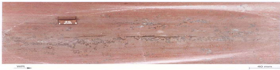
Şekil 6. 16: Malzemedeki boyuna çatlaklar [23]
