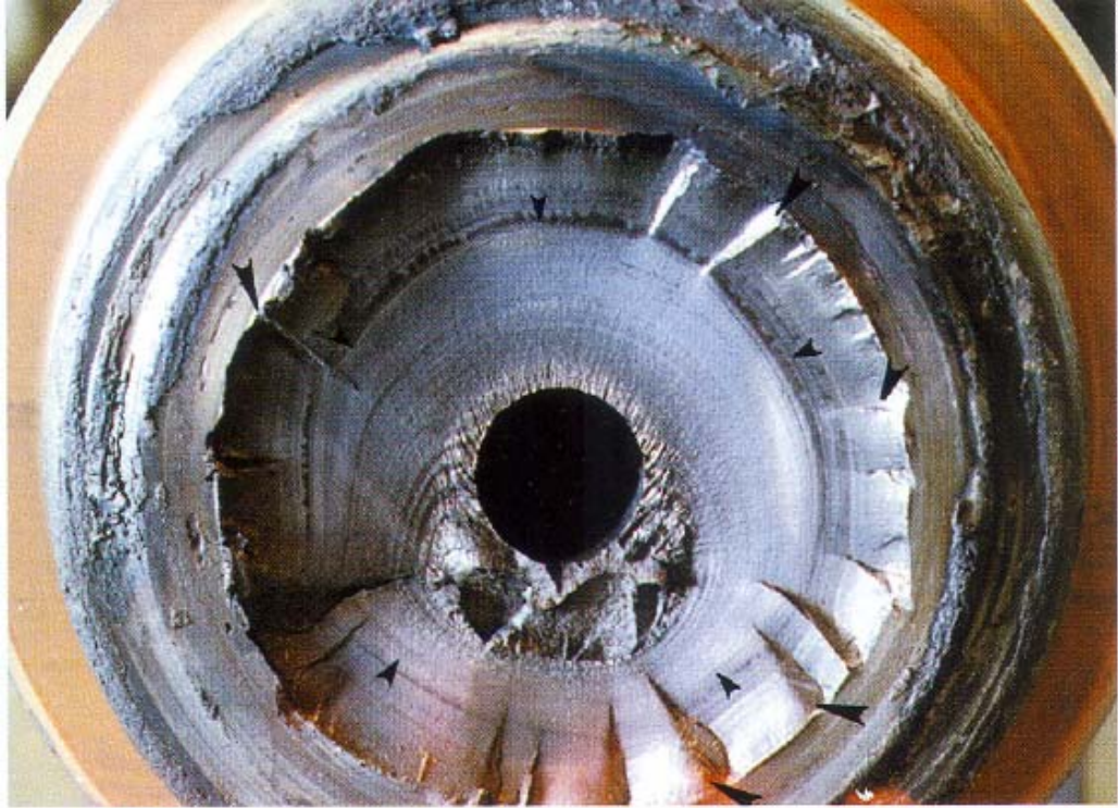
Şekil 11. 20: Döner eğilme yorulması nedeniyle kırılan bir merdane muylusu [29]
