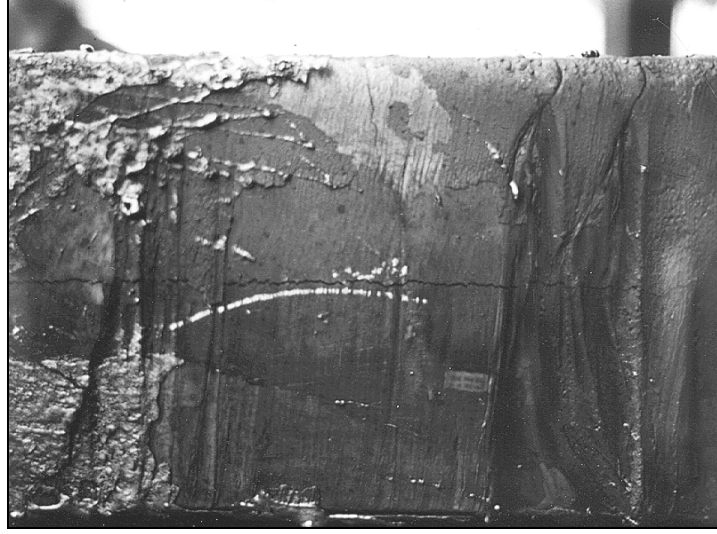
Şekil 6. 9: Slabta alın çatlağı kusuru [ 22]
