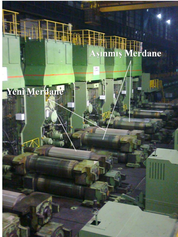
Şekil 11.17: Aşınan iş merdanelerinin üretim programına göre deęiřimi
