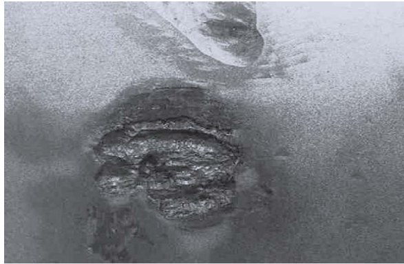
Şekil 11. 32: Merdanelerde oluşan mekanik izler [30]
