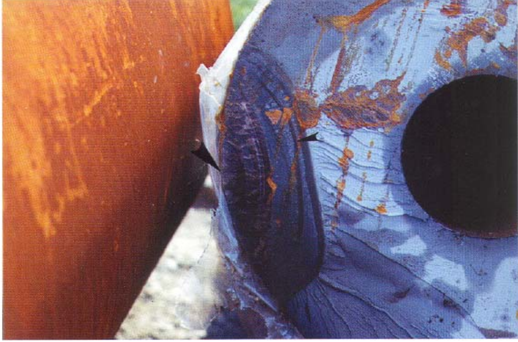
Şekil 11. 22: Dönen eğilme gerilmesi neticesi tek noktadan başlayan çatlak nedeniyle kırılan muylu [ 29]
