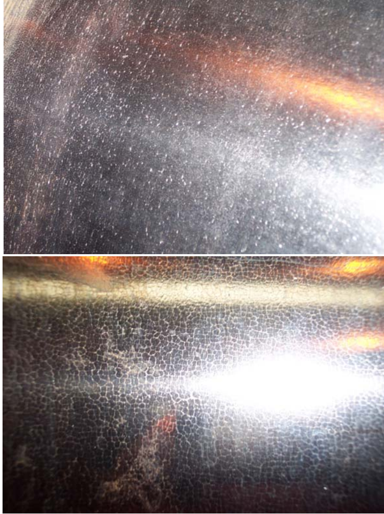
Şekil 11. 16: Aşınmış iş merdanesi yüzeyleri
