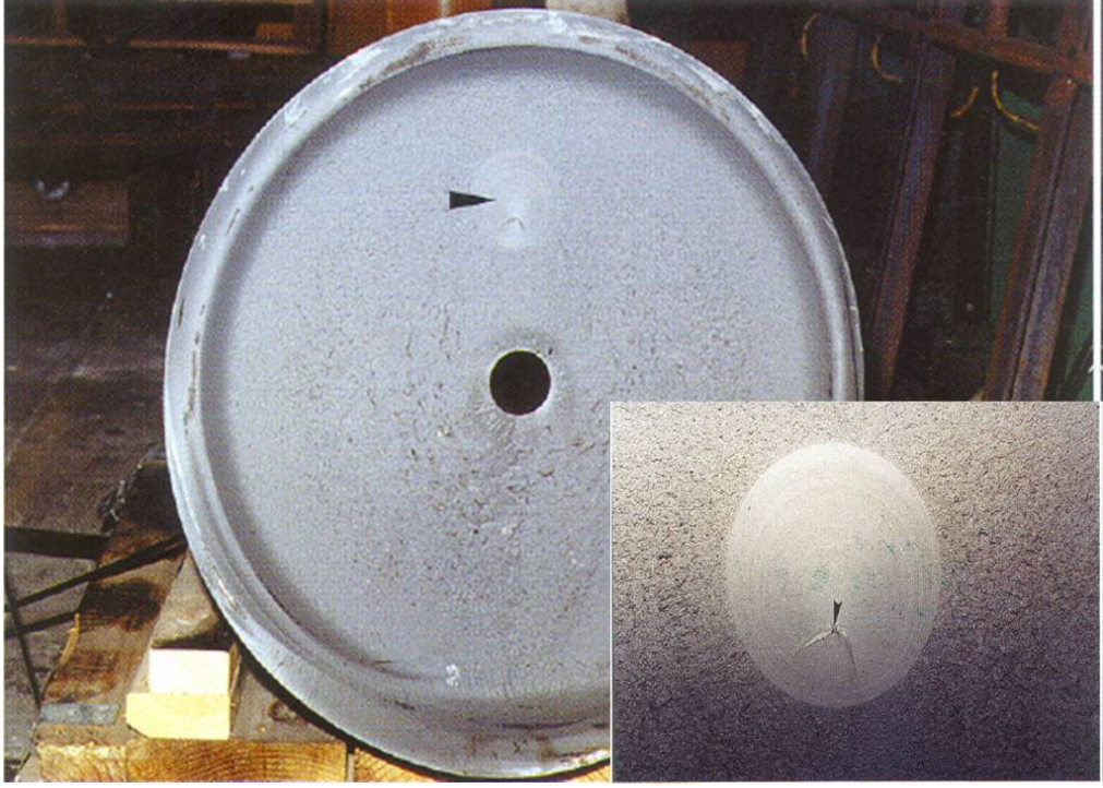
Şekil 11. 24: Yüzey altı kusuru nedeniyle kırılmış bir muylu görünümü [29]
