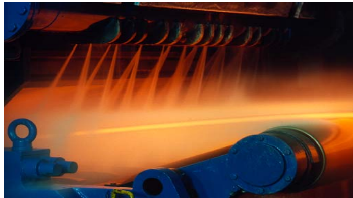
Şekil 10. 2: Tezgahlar arası soğutma sistemi
