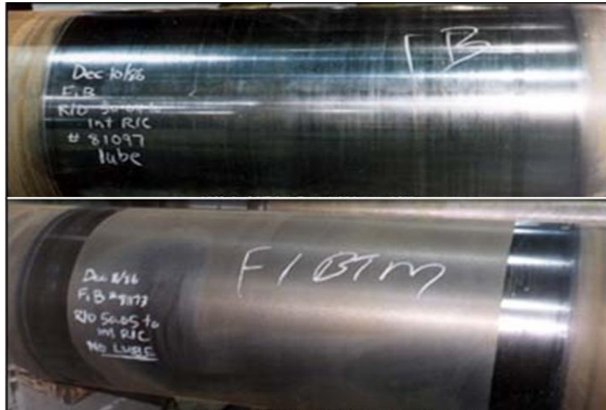
Şekil 10. 5: Hadde aralığı merdane yağlama sistemi kullanıldığı ve kullanılmadığı durumlarda iş merdanesindeki aşınma farkı
