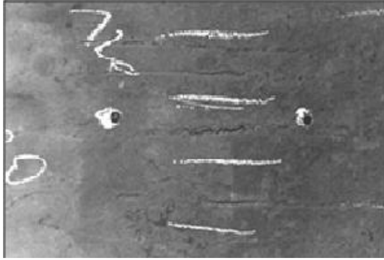
Şekil 6. 4: Slabta boyuna enine çatlağı kusuru [ 22]
