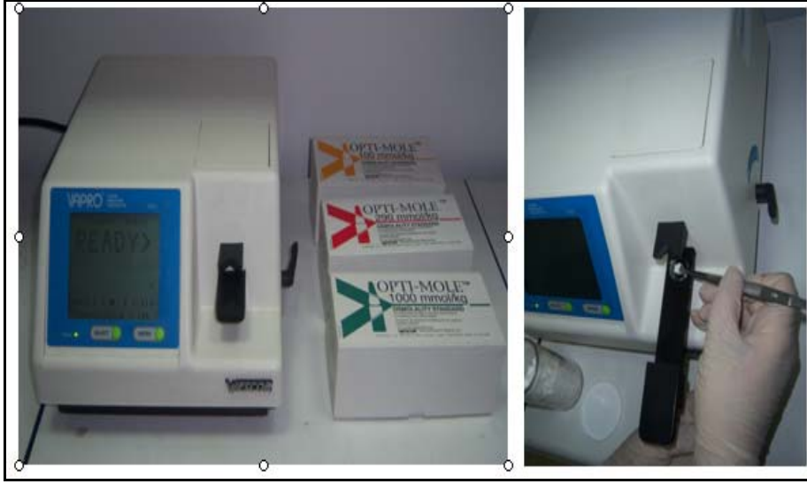
Şekil 3.2 Veisacor marka Vapro (Vapor Pressure Osmometer) 5520 cihazı, standartları ve kullanımı
