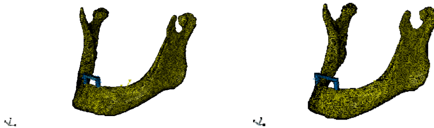
Şekil 3-9: İmplantlar arası mesafenin yakın ve uzak olduğu bar ataşmanlı modeller
