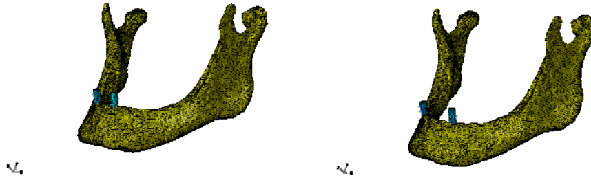
Şekil 3-10: İmplantlar arası mesafenin yakın ve uzak olduğu ball ataşmanlı modeller
