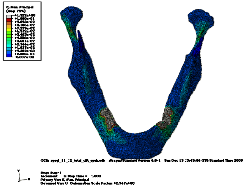
Şekil 4-43: Arkaya eğimli rezorbsiyon gösteren kretlerde geleneksel tam protez kullanıldığında çift taraflı dikey yükleme durumunda alt çene kemiğinde oluşan strain dağılımları
