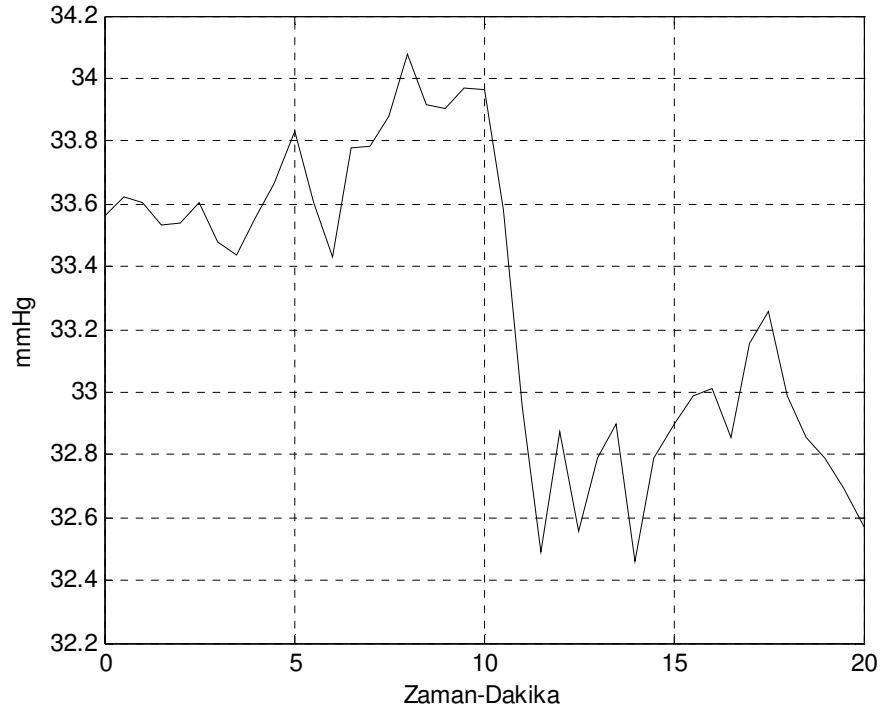
Şekil 5.29. Rat-5'in el ile kontrolünden elde edilen regülatör çıkış basınç değişimi
