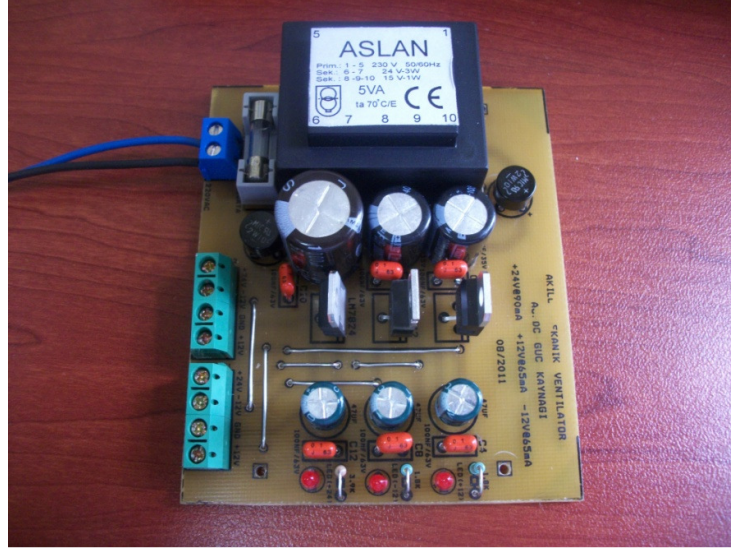
Şekil 5.4. 24V-90mA,12V-65mA, -12V-65mA'lik güç kaynağı
