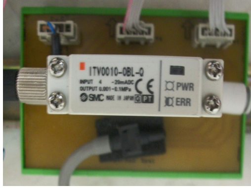
Şekil 5.6. Basınç regülatörüne ait elektronik kart düzeneği
