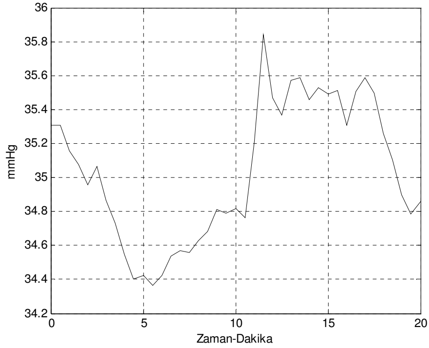
Şekil 5.33. Rat-7'nin el ile kontrolünden elde edilen regülatör çıkış basınç değişimi
